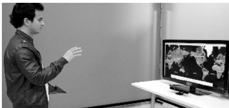
Fig. 6. Usuario interactuando con la aplicación Bing-Maps a través de la nueva componente de interacción multimodal. El componente Dispositivo hace uso del dispositivo Kinect (Microsoft) para la adquisición de audio y del movimiento de brazos/manos. La visualización se realiza en un monitor LCD 42”.
