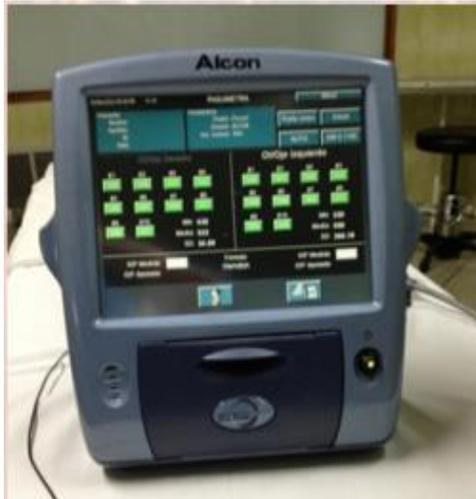
Figura 2: Equipo OcuScan (Alcon) para biometría ultrasónica
