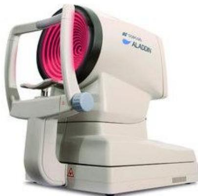
**Biómetro AL-Scan de NIDEK** : Se fundamenta también en la interferometría de coherencia parcial. Tiene la capacidad de medir 6 parámetros: longitud axial, queratometría, profundidad de la cámara anterior, paquimetría, distancia blanco-blanco (diámetro corneal), y tamaño pupilar. Usa un diodo que emite luz de 970 nm de longitud de onda. El poder de la córnea se mide mediante el análisis de las imágenes reflejadas de dos miras circulares a diámetros de 2,4 y 3,3 mm.
