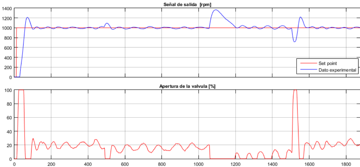
Figura 37. Respuesta del controlador predictivo frente a perturbaciones
