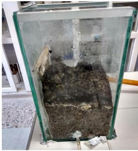
Biorreactor de hidrólisis enzimática por *Aspergillus niger*.
