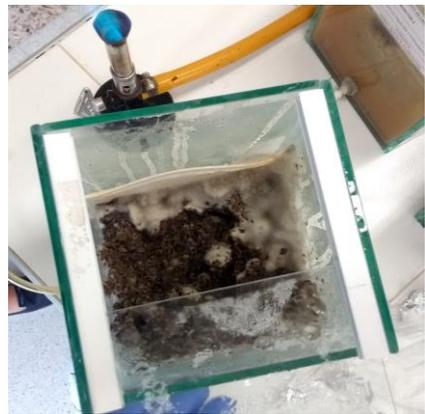
Biorreactor de hidrólisis enzimática por *Rhizopus* spp.
