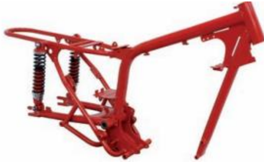
Ilustración 12: Chasis simple cuna abierto o interrumpido (Lopez, 2013)
