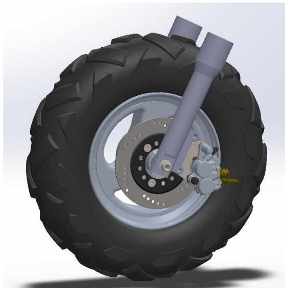
Ilustración 51: Llanta, freno de disco y parte de suspensión delantera CAD
