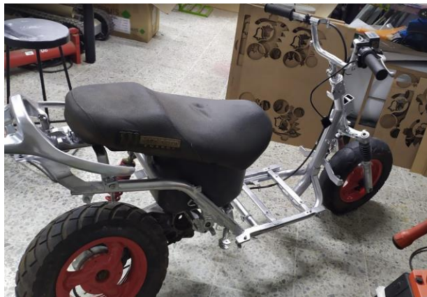
Ilustración 61: Montaje mecánico terminado
