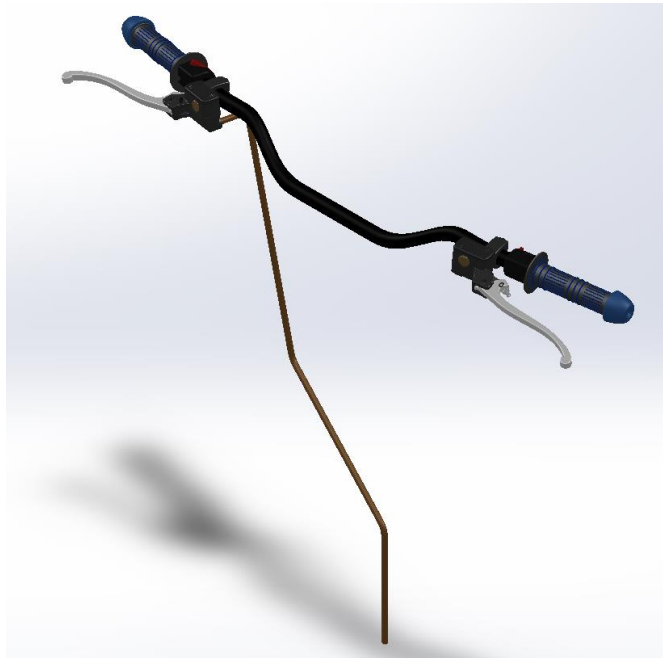
Ilustración 52: Diseño CAD del manubrio y de la bomba del freno
