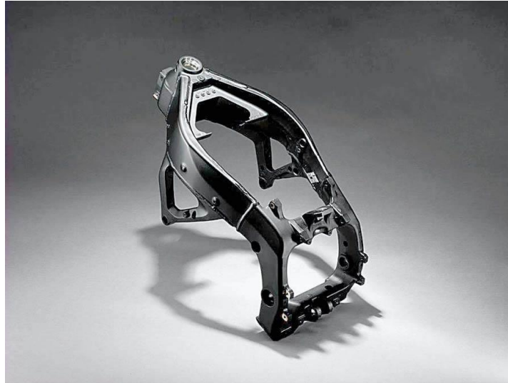
Ilustración 16: Chasis doble viga (Foale, 2002)
