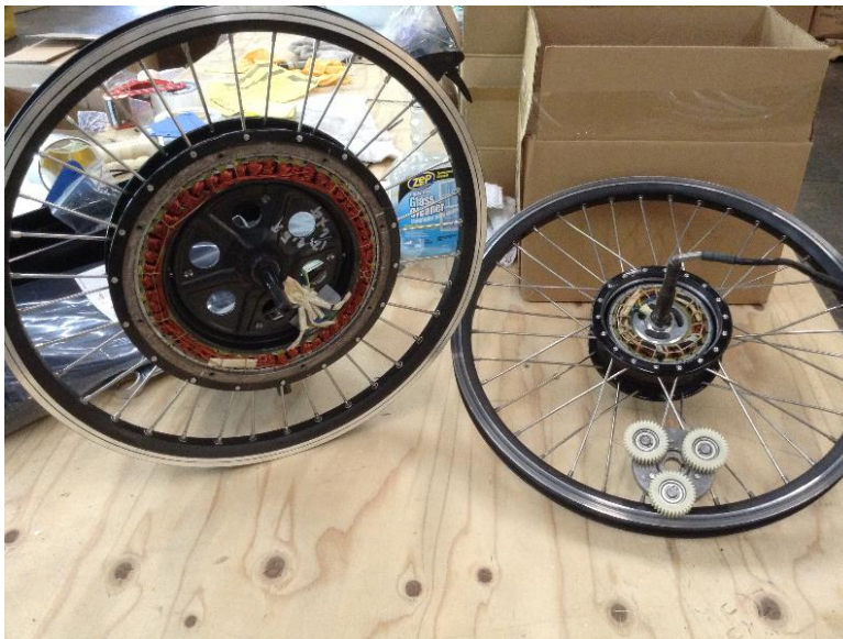
Ilustración 20: Motor ubicado en llanta con bobinados expuestos (Foale, 2002)
