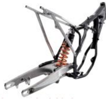
Ilustración 13: Chasis simple cuna desdoblado (Foale, 2002)
