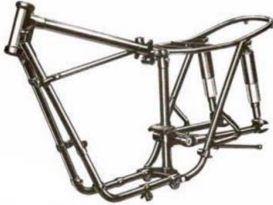
Ilustración 14: Chasis doble cuna (Foale, 2002)
