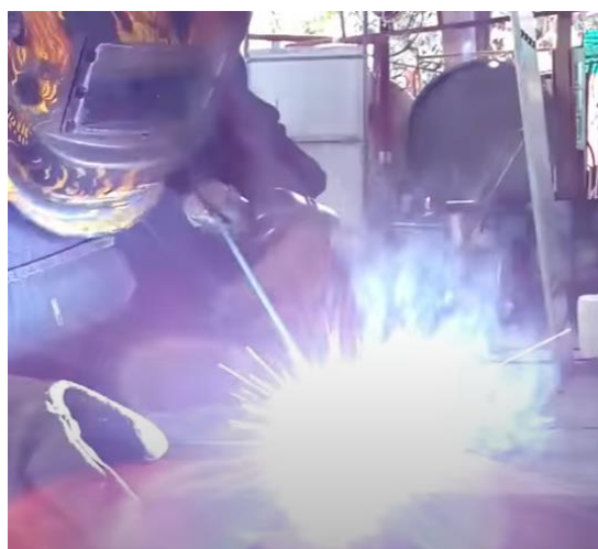
Ilustración 57: proceso de soldadura y electrodo usado.
