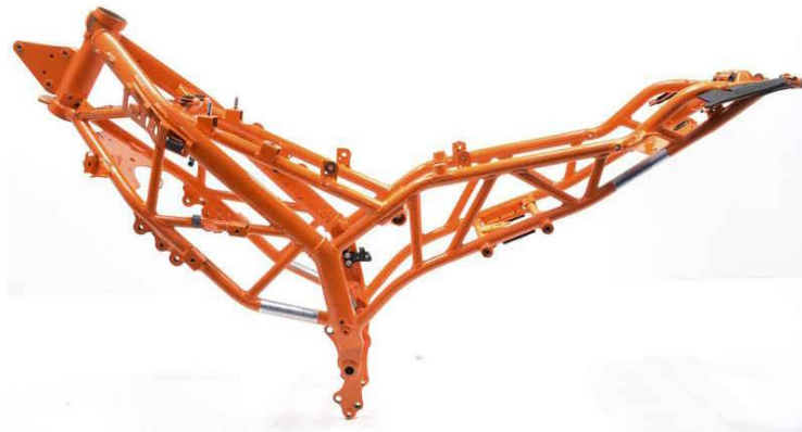
Ilustración 15: Chasis multitubular (Foale, 2002)
