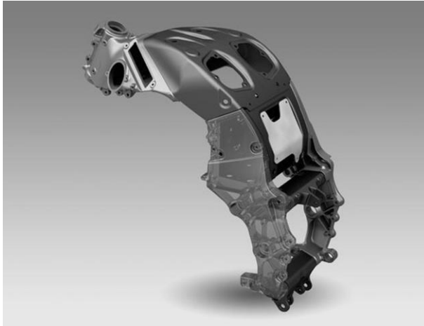
Ilustración 17: Chasis monocasco (Foale, 2002)
