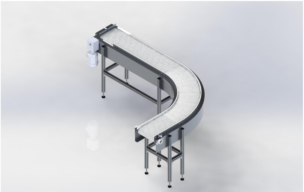
Figura 39. Banda transportadora curva, representación hecha en SolidWorks [33].
