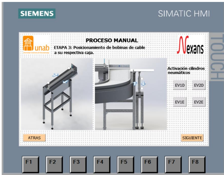
Figura 165. Interfaz proceso manual etapa 3, HMI [33].
