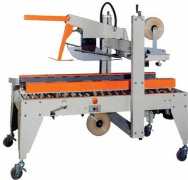
Figura 37. Sistema de sellado por medio de cinta adhesiva [34].
