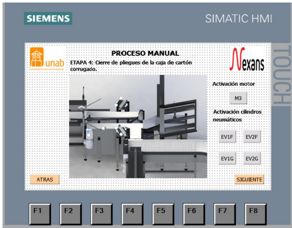
Figura 166. Interfaz proceso manual etapa 4, HMI [33].
