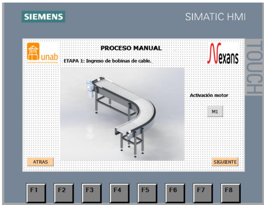
Figura 163. Interfaz proceso manual etapa 1, HMI [33].
