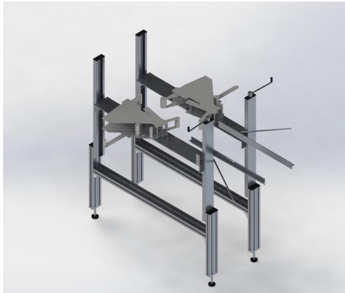
Figura 112. Soporte cabezal de grabado de cinta adhesiva, representación hecha en SolidWorks [33].
