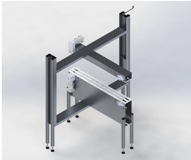
Figura 91. Sistema sellado de cajas de cartón corrugado, representación hecha en SolidWorks [33].
