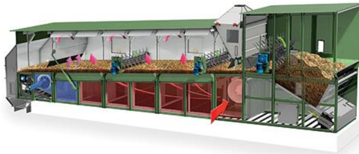
Figura 41. Secador de baja temperatura (de banda continua).
