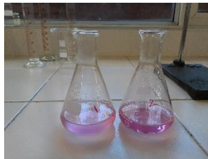
Figura 30 Muestras de prueba de índice de acidez del biodiesel Fuente: Elaboración propia
