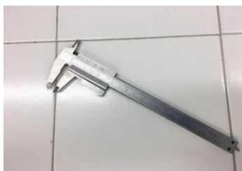
Figura 19 Calibrador o pie de rey Fuente: Elaboración propia
