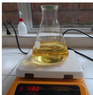
Figura 26 Calentamiento y agitación del aceite
