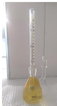
Figura 21 Pícnómetro Fuente: Elaboración propia
