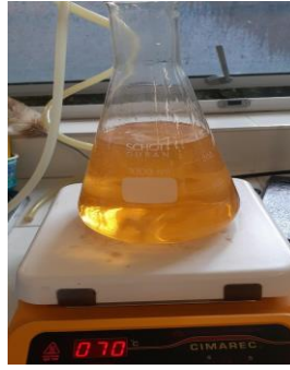
Figura 27 Mezcla de aceite con etanol y catalizador Fuente: Elaboración propia
