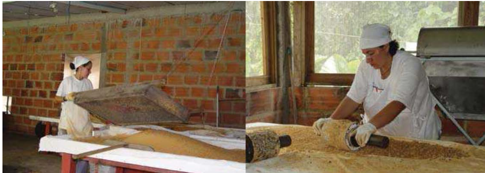
Figura 10. Separación de granos gruesos de los más finos y triturado de grano grueso.
