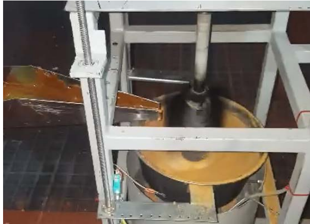
Figura 48 Proceso de batido y aireado en la maquina pulverizadora de panela
