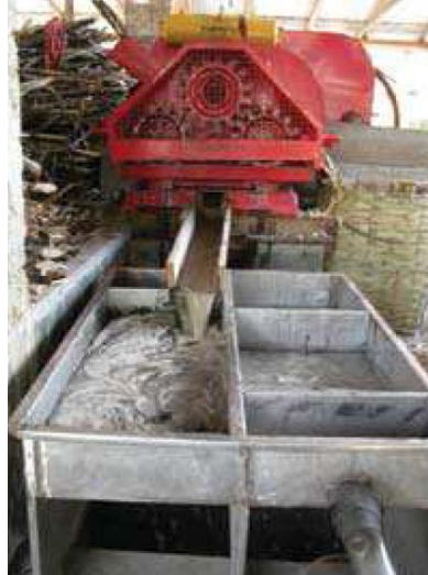
Figura 5. Pre-limpieza del jugo de caña de azúcar.
