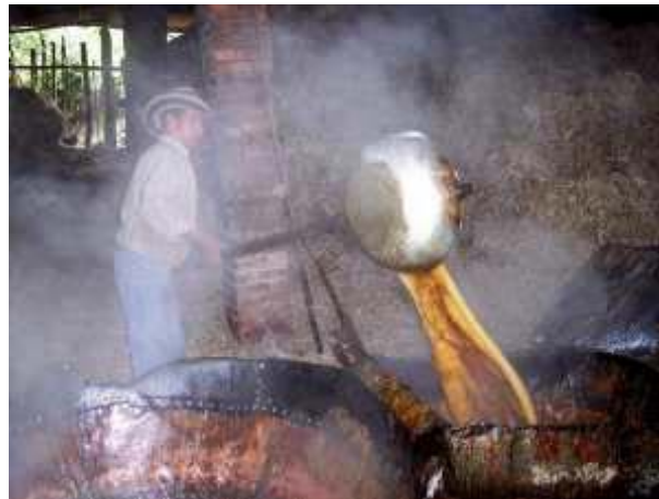
Figura 8. Batido y punteo del jugo de caña de azúcar deshidratado
