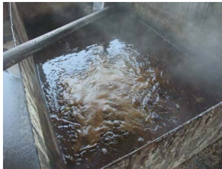
Figura 6. Clarificación del jugo de caña de azúcar
