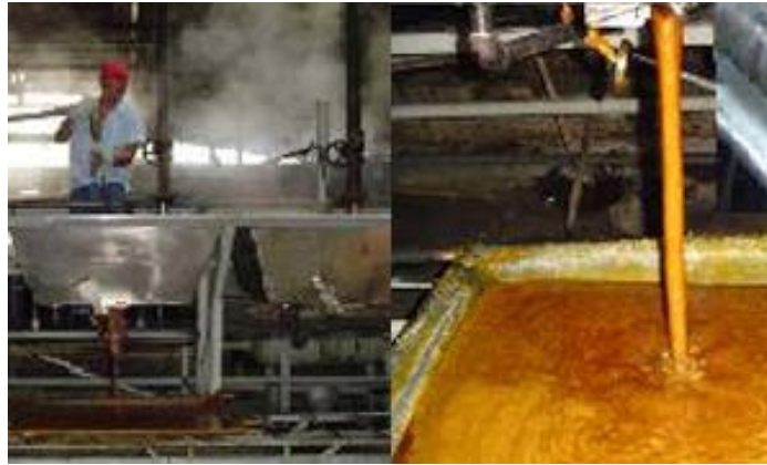
Figura 7. Evaporación y concentración del jugo de caña de azúcar.
