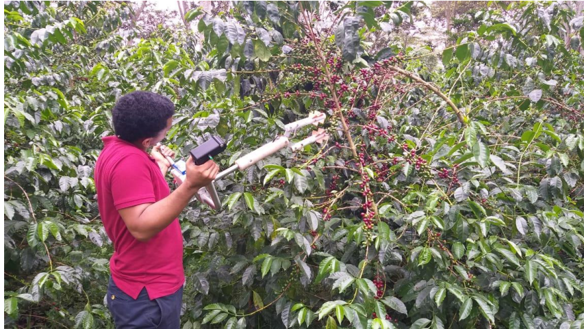
Ilustración 113. Prueba de desprendimiento de frutos maduros e impacto al cafeto [Autor]
