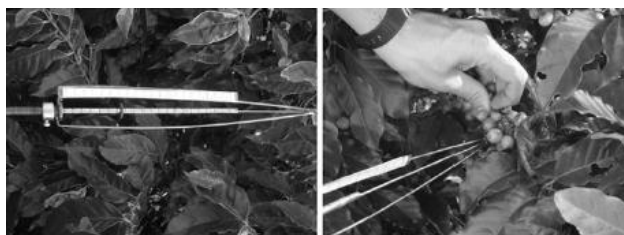
Ilustración 38. Medición de la fuerza de desprendimiento usando un dinamómetro [58]
