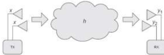
Figura 3. Sistema MIMO (múltiples entradas, múltiples salidas)
