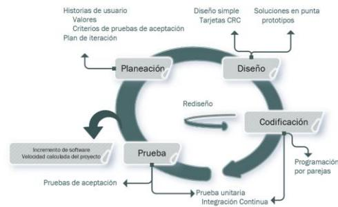
Fig. 3 El proceso de la programación extrema, Fuente: adaptado de Pressman [10]
