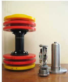
Fig. 1. HERRAMIENTA DE INSPECCIÓN INTELIGENTE ACOPLABLE A UN RASPATUBOS.
