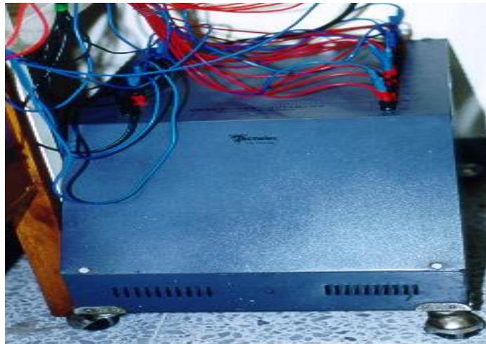
Figura N° 1-3. Fotografía del transformador de potencia utilizado como máquina de experimentación.
