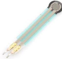
*Ilustración 13. Sensor de fuerza resistivo. Fuente [12].*
