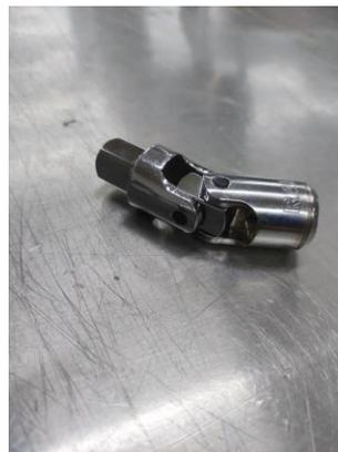
*Ilustración 79. Mecanismo tipo cardan. [Fuente autor]*
