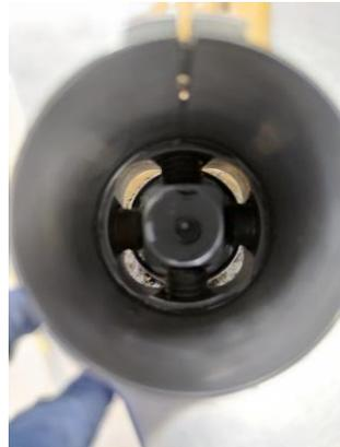
*Ilustración 82. Acople del mecanismo cardan al sistema modular. [Fuente Autor]*
