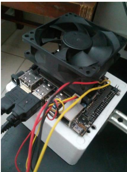
Figura 49. Adaptación física de la Jetson Nano
