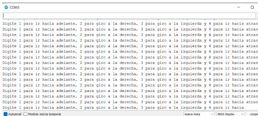
Figura 76. Resultados control del robot a través del monitor serial de Arduino
