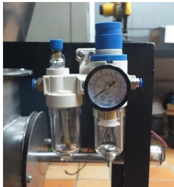
Ilustración 33 Unidad de mantenimiento fijada
