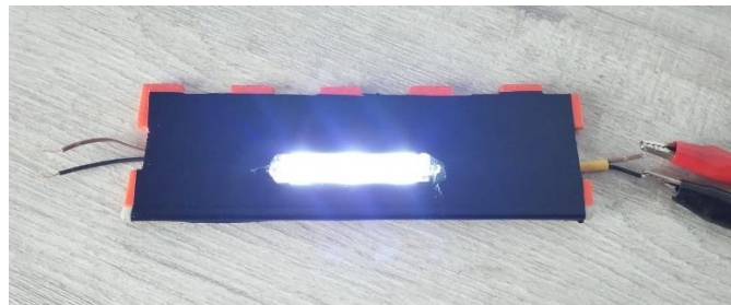
Ilustración 23 Prueba de funcionamiento de la cinta led en tapa lateral de la recámara
