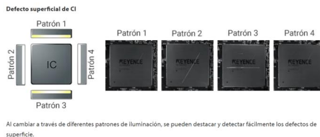
Ilustración 10 Aplicación de iluminación cuadrada en un CI
