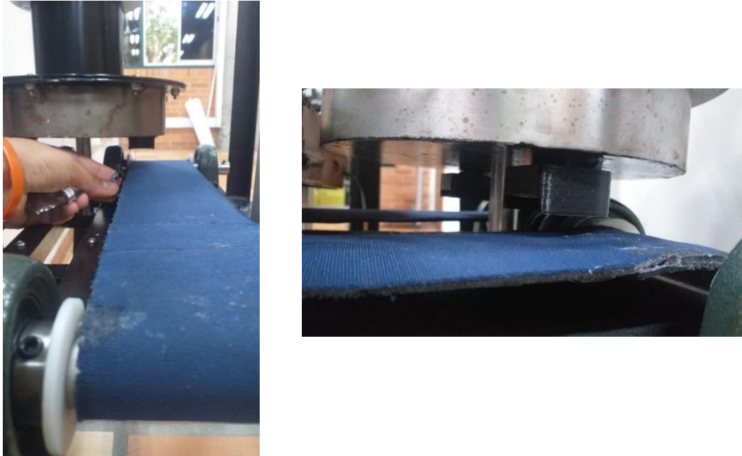
Ilustración 29 Nuevas cintas de las bandas transportadoras
