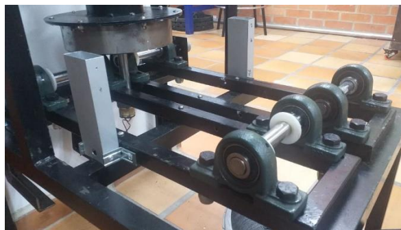
Ilustración 27 Soportes de aluminio para las recamaras de iluminación
