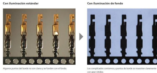
Ilustración 8 Aplicación de iluminación de fondo a una regleta de pines conectores
