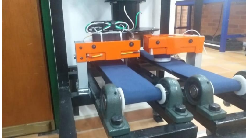
Ilustración 26 Recámaras de iluminación instaladas
