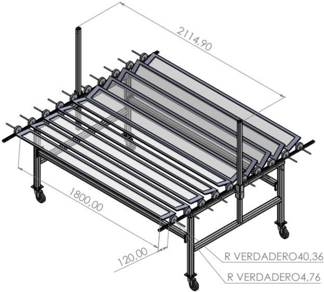
Figura 60. Vista lateral del sistema reflector primario con sus nuevas dimensiones.
