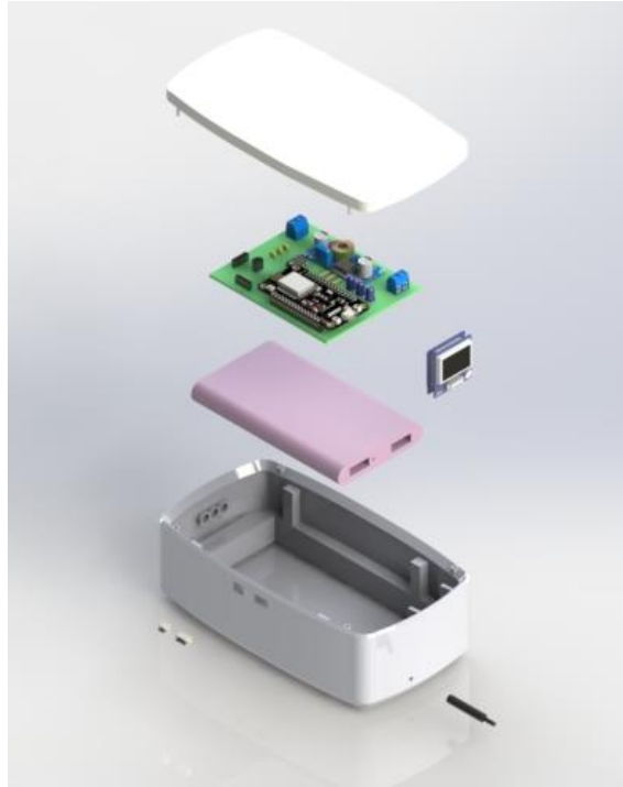
Figura 54. Modelo 3D explosionado del sistema integrado [Ver anexo 11].
