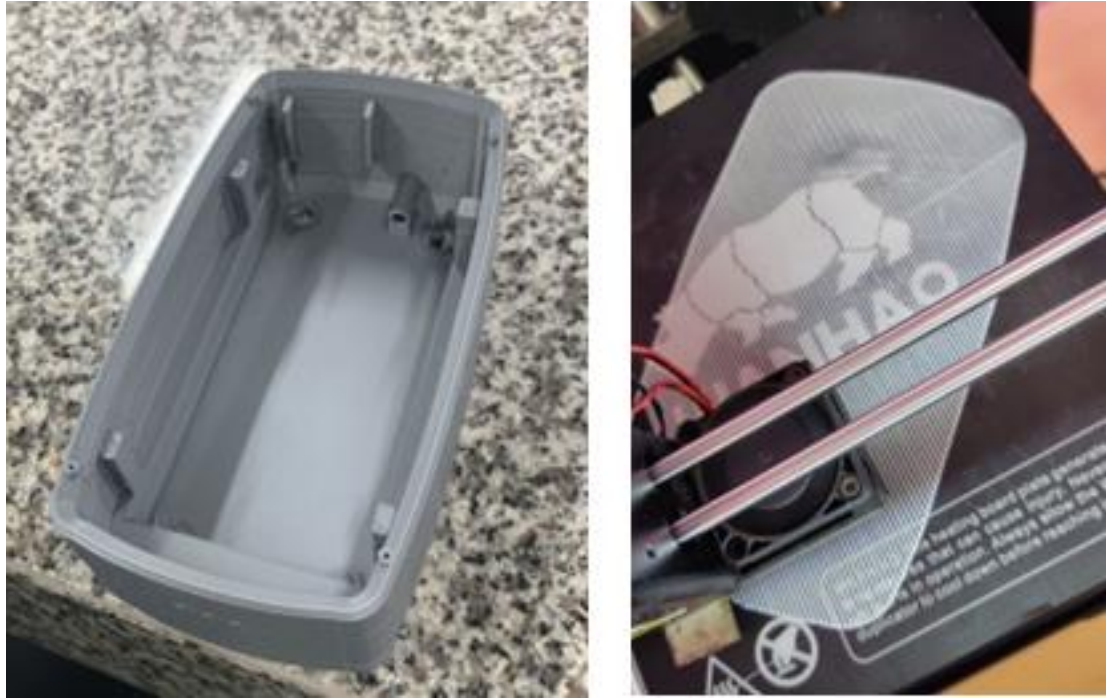
Figura 56. Impresión 3D de la carcasa del dispositivo.
