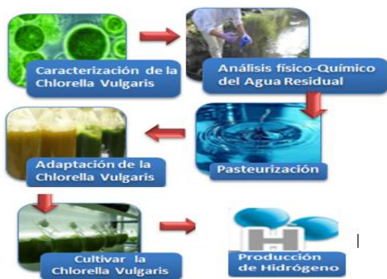
Figura 1. Procedimiento para la producción de biohidrógeno.
