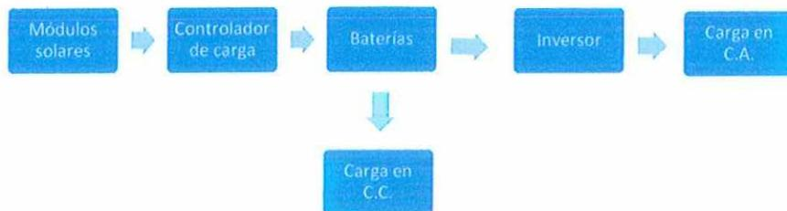
Figura 6. Diagrama de bloques de una instalación fotovoltaica autónoma
