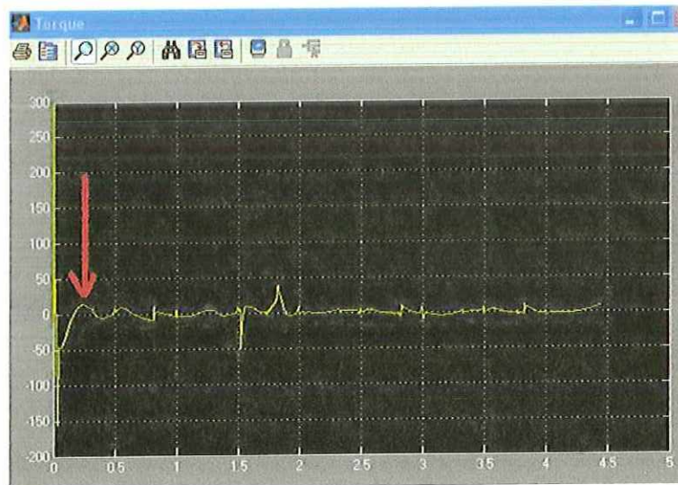
Figura 117. Torque generado por el actuador de la pierna izquierda en la fase de balanceo.
