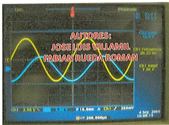
Figura 148. Funcionamiento del filtro pasa-altas de segundo orden
