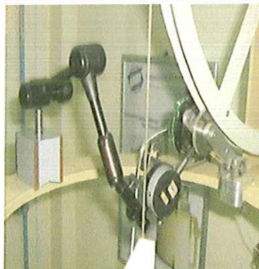
Figura 6 Montaje prueba de excentricidad
