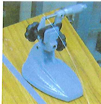
Figura 9 Medición de diámetro de las cuerdas.
