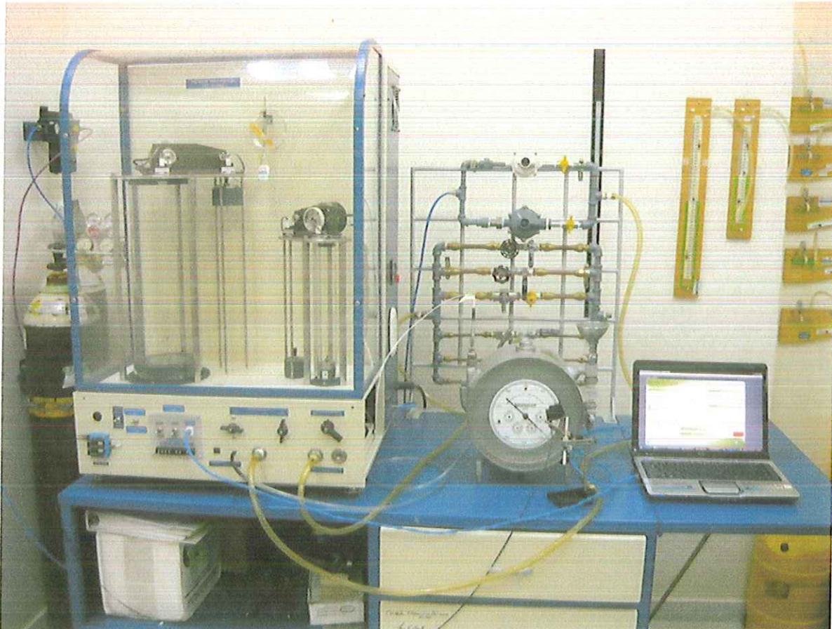
Figura 28 Calibración de Cámara Húmeda con Pistón
