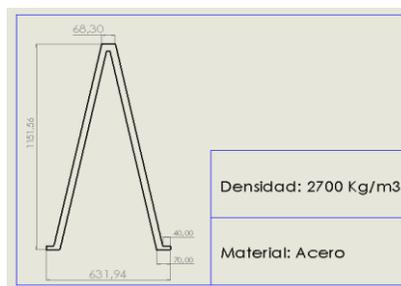
Figura 14. Sección transversal de la tubería general y características. Fuente: Autores.
