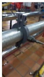
*Figura 48: Adaptador de sensor. Fuente: Autores.*
