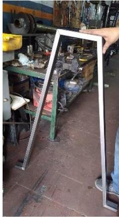
*Figura 43: Soportes para apoyar la sección de tuberías. Fuente: Autores.*
