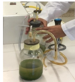
Figura 3. Montaje de fotobiorreactores con oxigenación.
