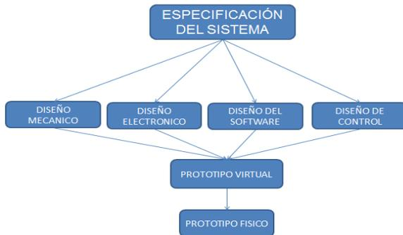
Figura 2, Metodología diseño Mecatrónico [2]
