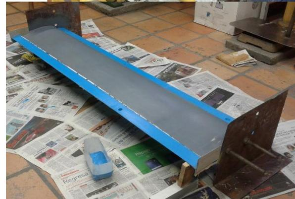
5. Se corta fibra de carbono de 152 cm x 27 cm, la línea de corte se traza con cinta de enmascarar para evitar que la fibra restante se dañe durante el corte que se hace de forma manual con unas tijeras.
