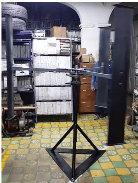
**Figura 33.** Primer ensamble completo aerogenerador <sup>[AUTOR]</sup>
