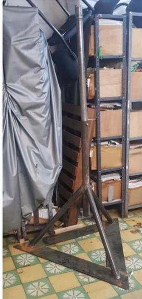
**Figura 31.** Base trípode con eje telescópico [AUTOR]
