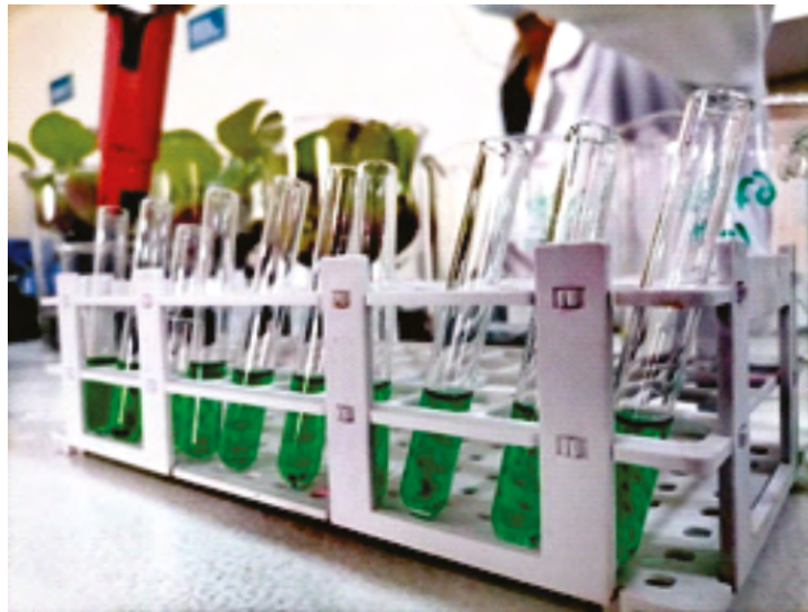
Imagen 2. Medición de Amonio con protocolo de colorimetría Kit Api para acuicultura.
