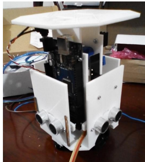
Figura 34. Diseño de la plataforma robótica impreso en PLA
