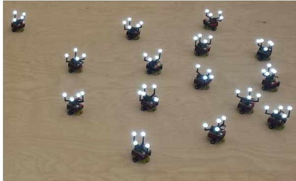
Figura 3. Enjambre robótico de 15 GRITSBots
