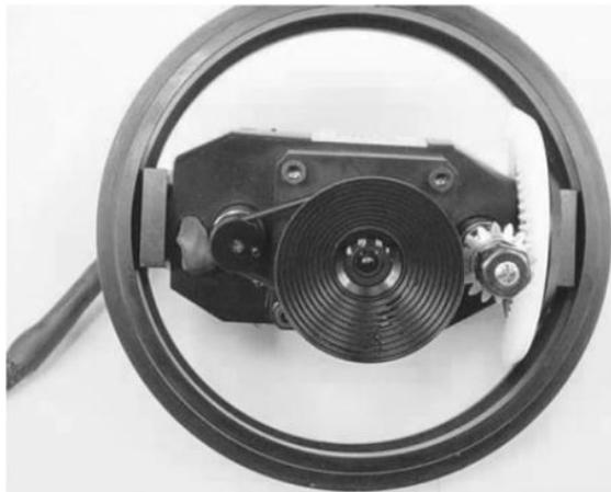
**Figura 6** Cámara con mecanismo de rotación [23]
