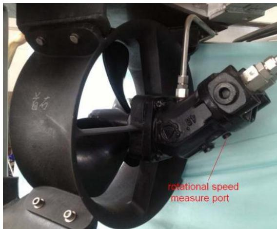
**Figura 5** Propulsor hidráulico [24]
