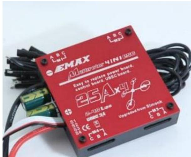
**Figura 3** Controlador de velocidad para un motor Brushless [22]
