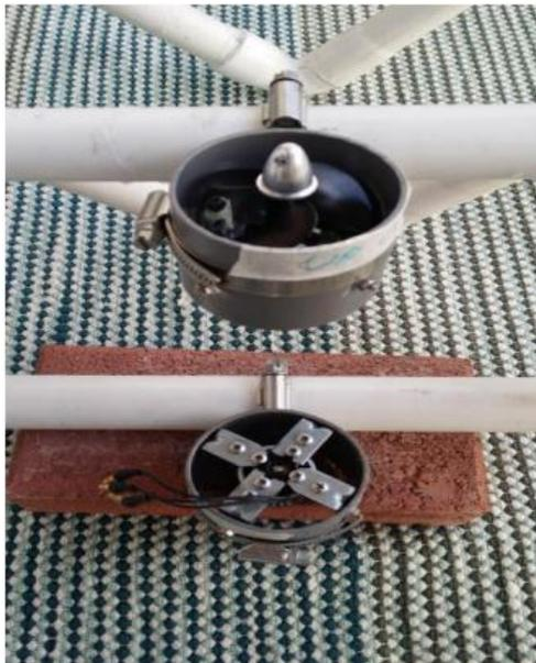
**Figura 2** Propulsor con motor Brushless [22]
