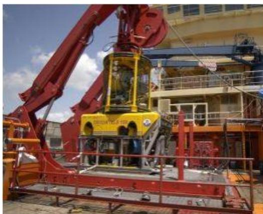
**Figura 16** Ejemplo de un ROV de trabajo junto con un TMS de tipo sombrero y su Sistema de lanzamiento y recuperación [22]
