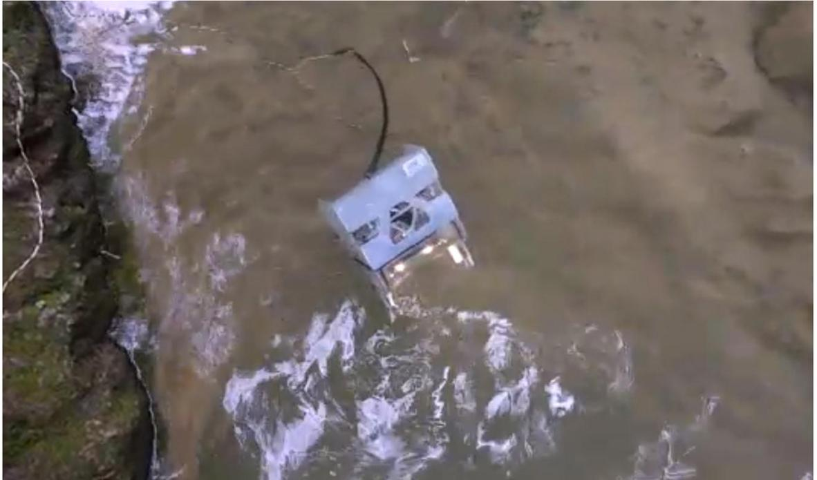
**Figura 108** Prueba de velocidad ROV en ambiente con perturbaciones
