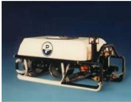
**Figura 15** Ejemplo de un ROV alta capacidad eléctrica [22]
