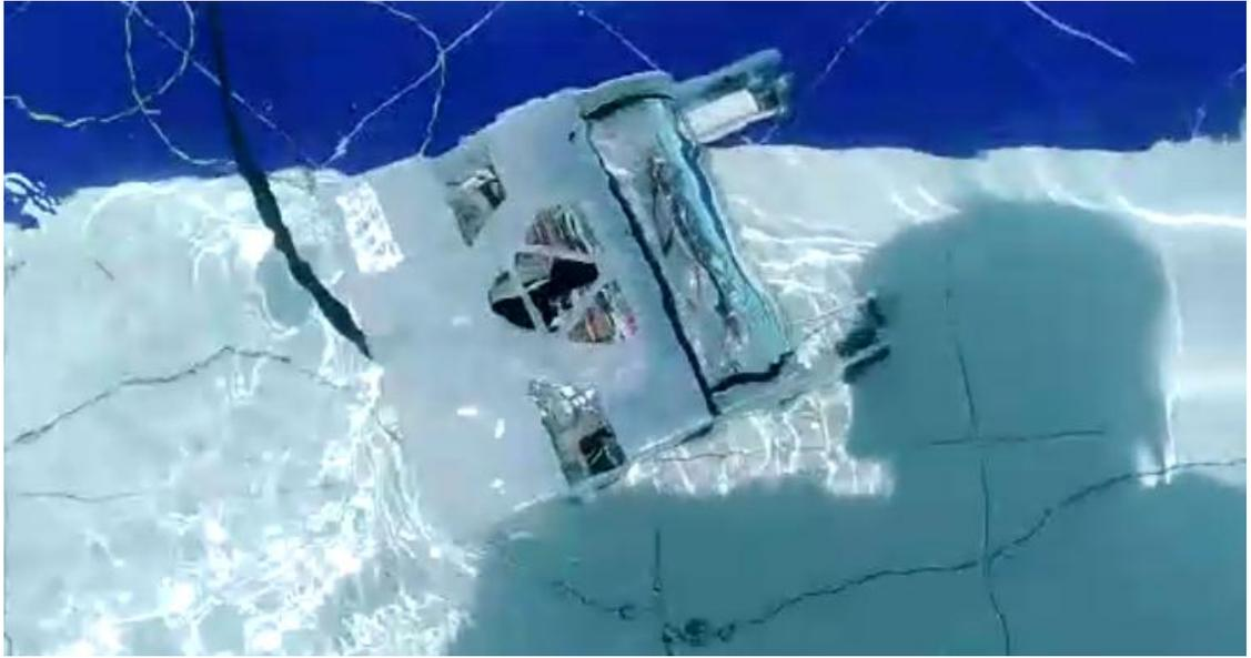
**Figura 104** Prueba de profundidad ROV en ambiente controlado
