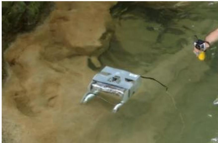
**Figura 107** Prueba de velocidad ROV en ambiente con perturbaciones
