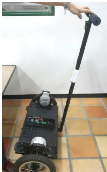
Figura 8. Inclinación del vehículo hacia adelante.
