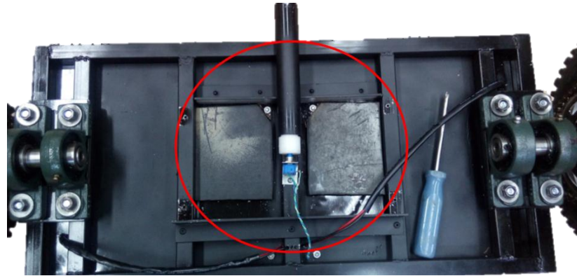
Figura 30. Ubicación las baterías y el potenciómetro.
