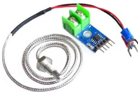
Figura 9. Termocupla tipo K – Modulo Max 6675 de Arduino (Duino LK, s.f.)
