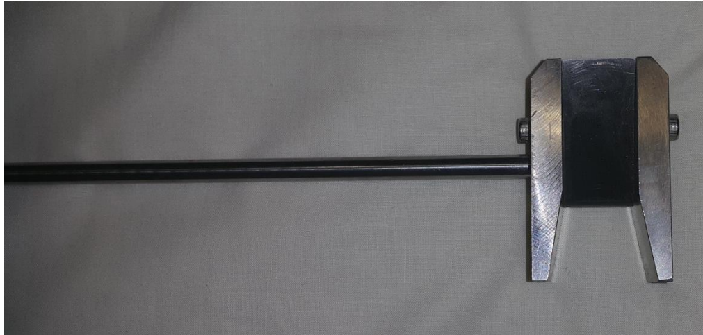
Figura 58. Ensamblaje eje y nariz de golpeo.
