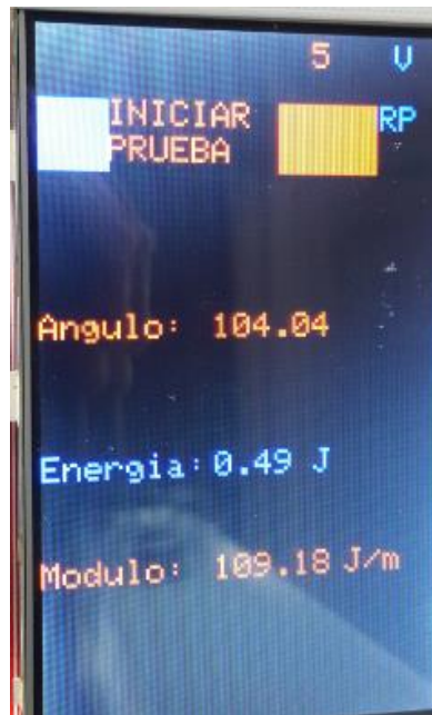
Figura 73. Pantalla táctil tras prueba de impacto.
