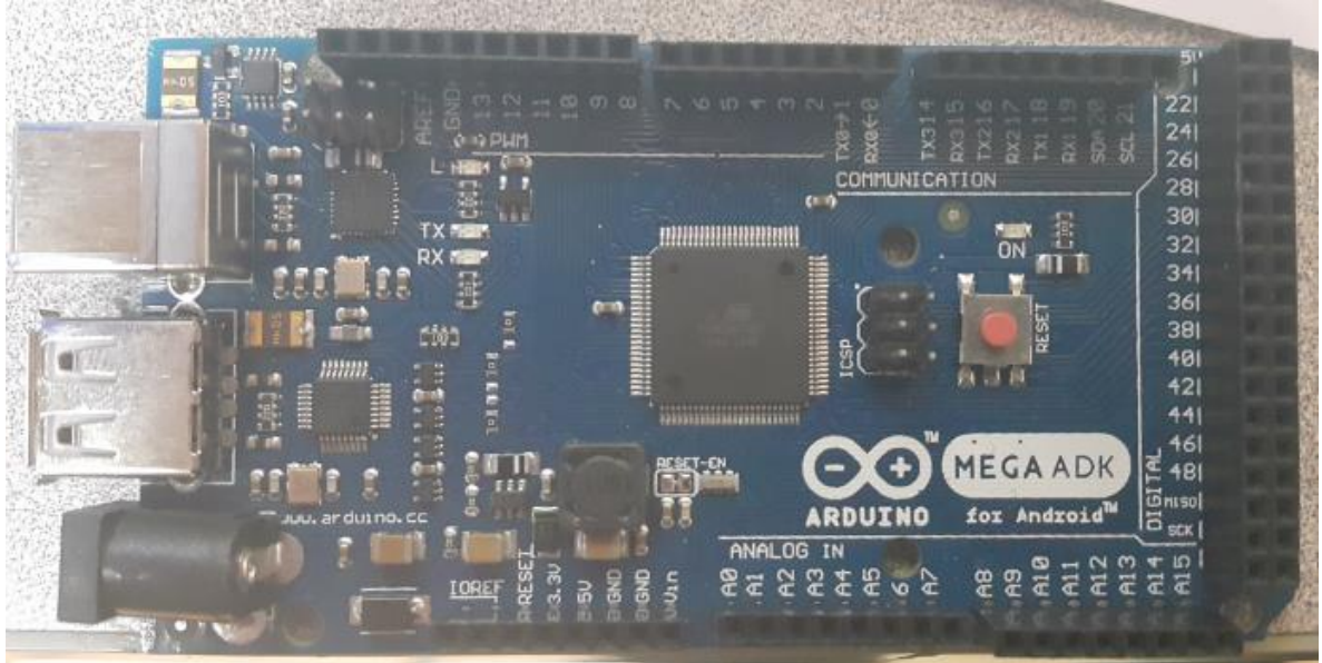
Figura 38. Arduino mega ADK.
