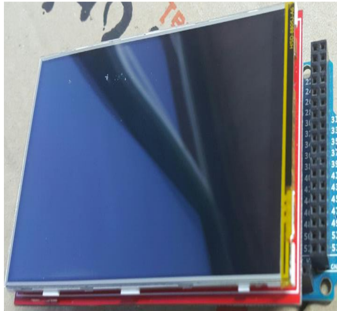
Figura 39. Pantalla LCD TFT de 3.97pulgadas para Arduino mega, acoplada a un Arduino mega.
