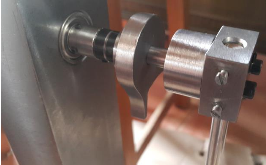
Figura 57. Unión del soporte principal, rodamiento y el eje.
