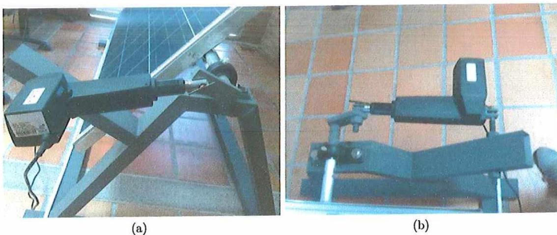
Figura 14: Mecanismo de giro con actuador lineal en el seguidor
