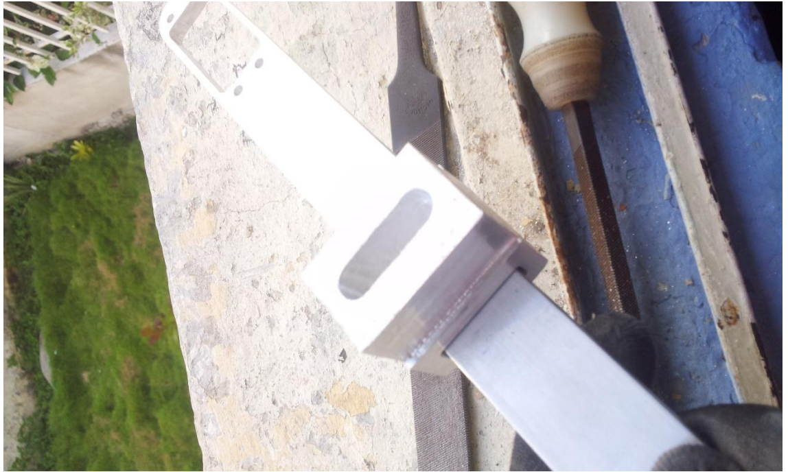
Ilustración 52 : PERFORACIÓN PARA UNIONES
