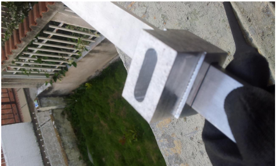
Ilustración 53 : PERFORACIÓN PARA UNIÓN
