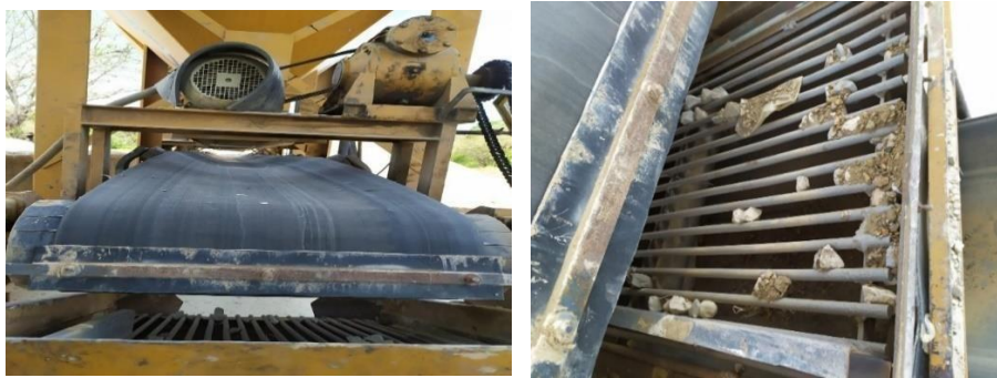
Figura 6. Banda Colectora de material y Malla Zaranda
