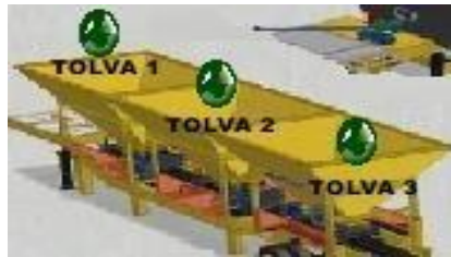
Figura 71. Tolvas de material Pétreo
