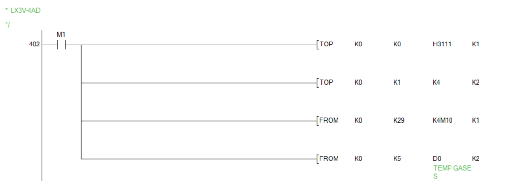
Figura 41. Comunicación módulo de conversión A/D
