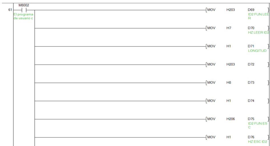
Figura 39. Lectura de registros comunicación Modbus.
