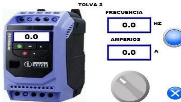
Figura 86. Variador de frecuencia 3
