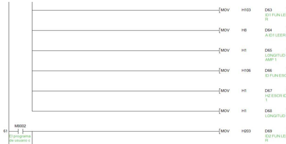
Figura 38. Lectura de registros comunicación Modbus.
