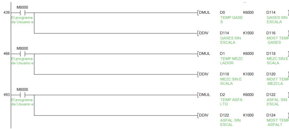
Figura 45. Escalamiento de la señal de temperatura
