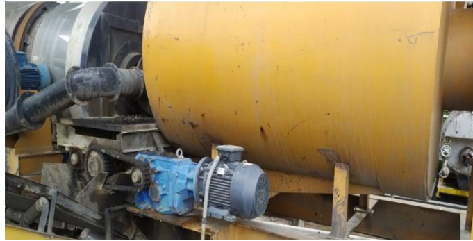
Figura 11. Tambor mezclador - Quemador - Colector de finos
