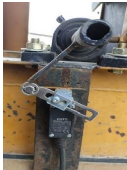
Figura 48. Mecanismo Final de carrera.
