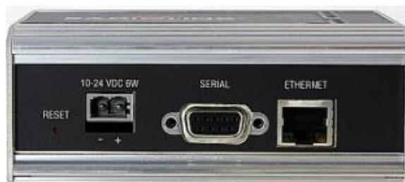
**Fig 16.** Parte posterior del HotSpot
