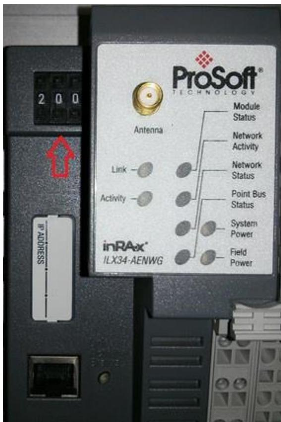
**Fig 23.** Ruedas de direccionamiento IP
