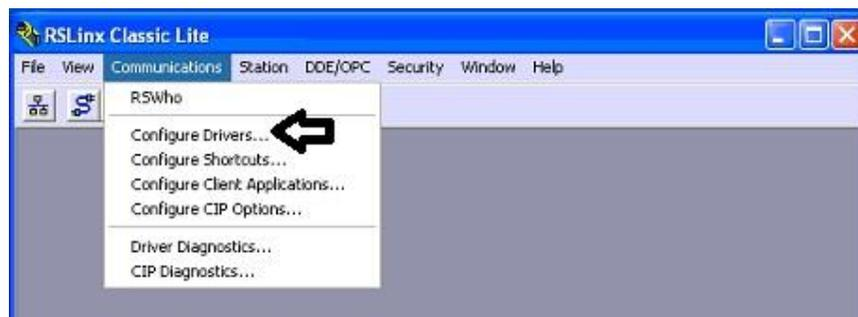
**Fig 31.** Configuración de driver de comunicación
