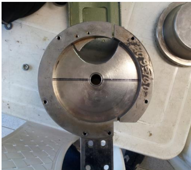
Ilustración 104 Ensamble de g Ensamble de guías semicirculares y bastidor
