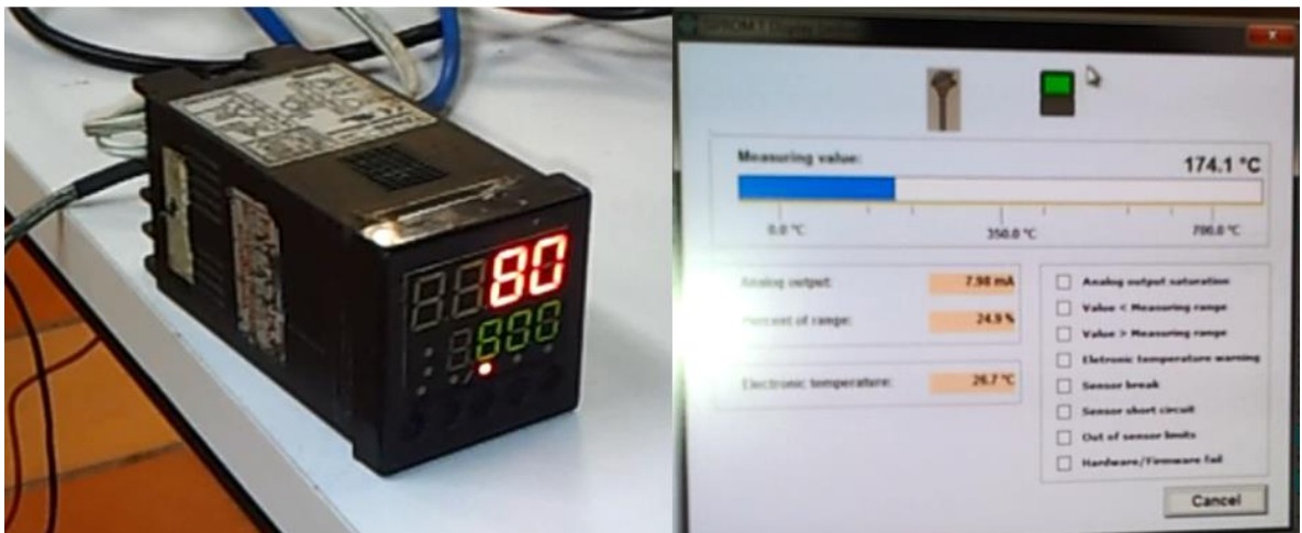
Ilustración 151 Temperatura en los visualizadores Izquierda valor erróneo. Derecha lectura real
