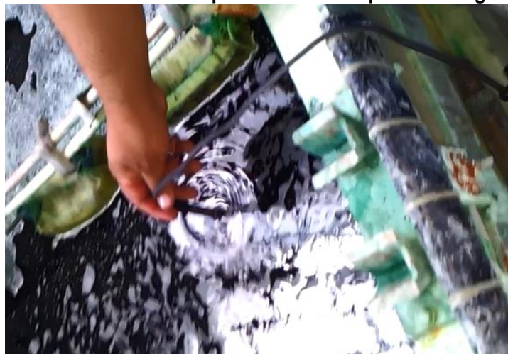
Ilustración 138 Medición de parámetros en el proceso de galvanía
