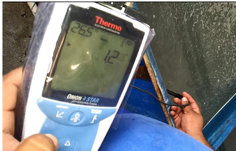
Ilustración 137 Medición de parámetros en el proceso de galvanía
