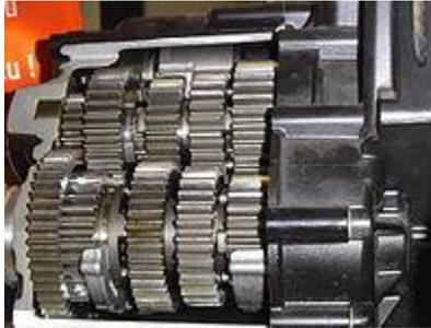
Figura 8- Engranajes constituyentes de la caja de cambios de un motor.
