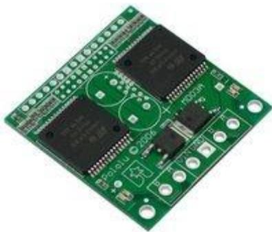
Figura 24 - Tarjeta de Potencia Pololu VN3SP30 [20]
