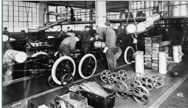
*Figura 4. Línea de ensamblaje implementada en la manufactura del ford modelo T. Imagen tomada de Discovery Networks International.*
