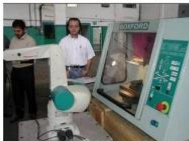
*Figura 5.9. Estacion de proceso conformada por un torno CNC el cual es cargado por un brazo robotico.*
