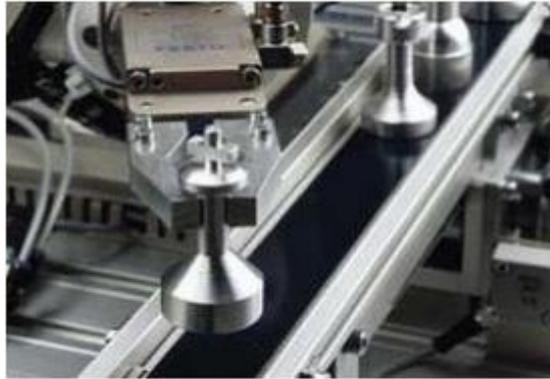
*Figura 5.8. Estacion de distribucion en una celda de manufactura.*
