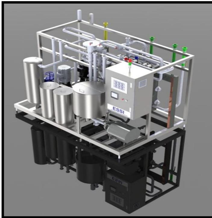
**Figura N° 31 Vista isométrica de la máquina empacadora aséptica ESSI A3.**
