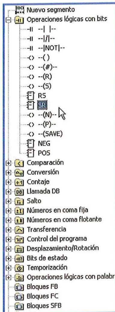
Agregue un segmento al entorno de trabajo, en la librería de funciones despliegue la carpeta *Operaciones lógicas con bits*, Step 7 tiene a su disposición dos tipos diferentes de F-F (Flip-Flop's) los SR y los RS. Para habilitarlos basta con seleccionar su figura de la librería y desplazarla hacia el segmento de trabajo.
