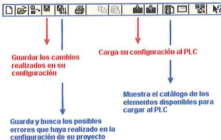
Mientras se está cargando la configuración al módulo se desplegarán ventanas emergentes como **Seleccionar módulo de destino** y **Seleccionar dirección de estación**, las cuales hay que aceptar teniendo en cuenta que la información que ellas contengan sea coherente.
