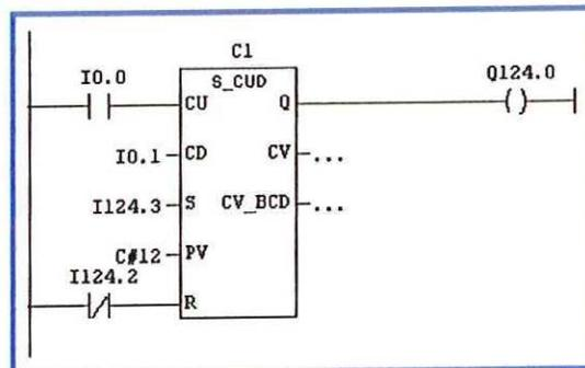
Este contador tiene la capacidad de contar pulsos de forma ascendente o descendente, el módulo consta de un selector de uso (CU,CD), un cargador de inicio de conteo (S), un inicio de conteo (PV), un reseteador (R), una
