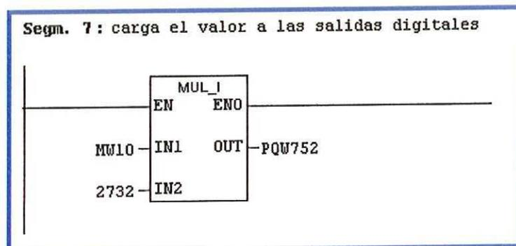
Al multiplicar el valor del voltaje deseado por la pendiente, se dará como resultado un número digital que la salida análoga interpretará dentro de su lógica como 5V. Compruebe este resultado con el multímetro.
