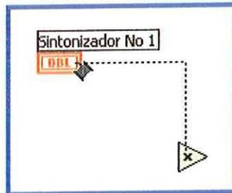
Si el objeto y la función están unidas mediante una línea de color, significa que la conexión es correcta.
