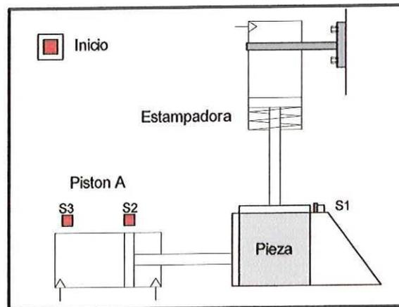
Hay tres sensores de posición para determinar el estado de los pistones. Dos para A que es de doble efecto, y uno para la estampadora que es de simple efecto.
