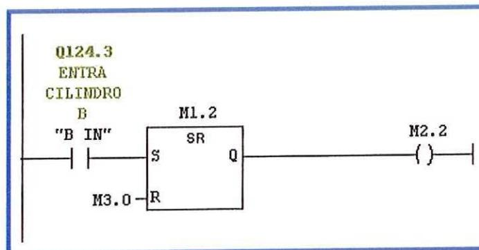
El siguiente paso, que es la liberación de la pieza no requiere de memorización por ser el último. Las condiciones para que se pueda ejecutar son B-, A+ y que el paso anterior se halla cumplido.
