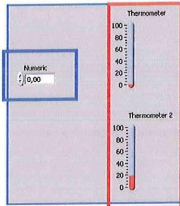
Ya insertados los objetos dentro del espacio de trabajo, es necesario editarlos para tener una buena visualización y entendimiento durante el procedimiento del programa. Para esto se etiquetan la entrada como *Temperatura en Centígrados* y la salidas como *Temperatura en Fahrenheit* y *Temperatura en Kelvin*. Además se insertan unos visores (**Digital Display**) a los termómetros para tener una mejor lectura .
