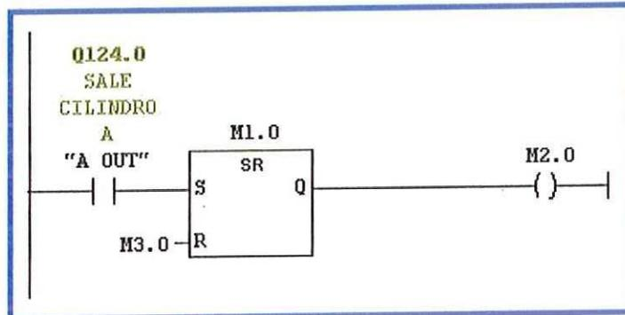
Este paso es el que se ocupa de activar la bobina que controla la salida del pistón B, las condiciones de esta etapa son A+, B- y que el orden anterior se haya cumplido (una activación de la marca M2.0). R se conecta con la marca M2.2.
