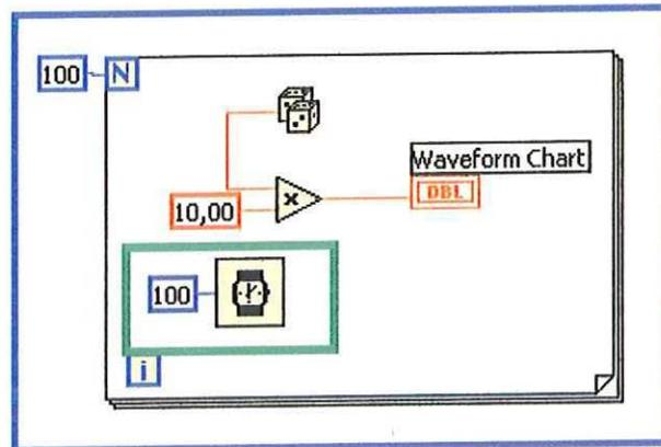
La nueva función utilizada se llama *Wait* (Espera), Wait genera un retardo entre ciclo y ciclo en un tiempo de x milisegundos, para el ejemplo 100 ms. Esta función de retardo se obtienen desde el submenú *Functions*, la casilla *Time & Dialog*. Realice el diagrama y observe el comportamiento.
