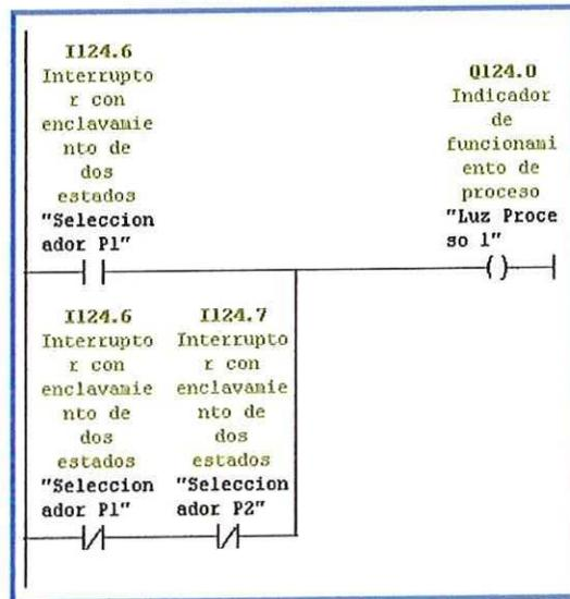
Con un control similar al usado para la selección de los procesos, las luces se encenderán según la posición de la perilla.
