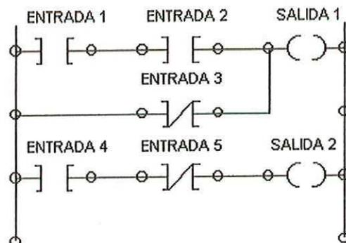
Para la imagen anterior la salida 1 se activará si las entradas 1 y 2 están conectadas, también se activará cuando la entrada 3 se desactive. En cambio la salida 2 sólo se activará si la entrada 4 esta conectada y la entrada 5 este desconectada.
