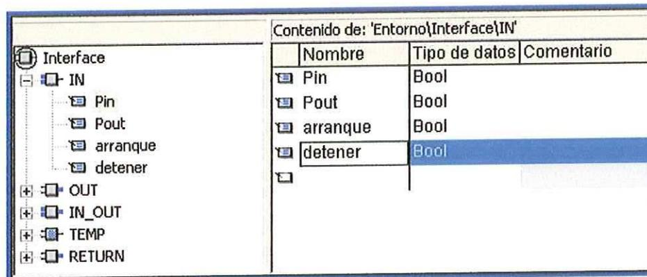
*Pin*, es la señal del sensor de posición cuando el pistón entra, *Pout* cuando este sale, *arranque* es la señal de START y *detener* STOP, se usan estas referencias genéricas porque la misma función controlará ambos pistones.
