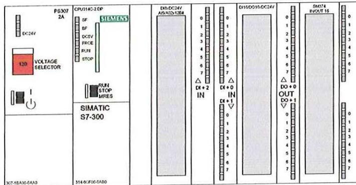
El PLC Siemens Simatic, se alimenta de una fuente de Corriente Alterna de 120 V ó 240 V dependiendo del modelo, además a esta alimentación, requiere de una conexión a tierra como en los computadores caseros. El PLC viene con su referencia de puesta a tierra, el cual se trata una lata metálica, sobre la cual este se sostiene, esta tierra se debe conectar con el polo a tierra del establecimiento para tener una referencia común.
