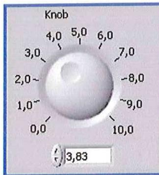
Supongamos ahora que el knob es uno de varios sintonizadores que tiene un sistema. Es necesario etiquetarlo para poderlo diferenciar de los otros y de esta forma evitar errores de operación. Para esto el submenú **Tools**, seleccione la opción **Edit Text**. El Mouse volverá a cambiar su forma.
