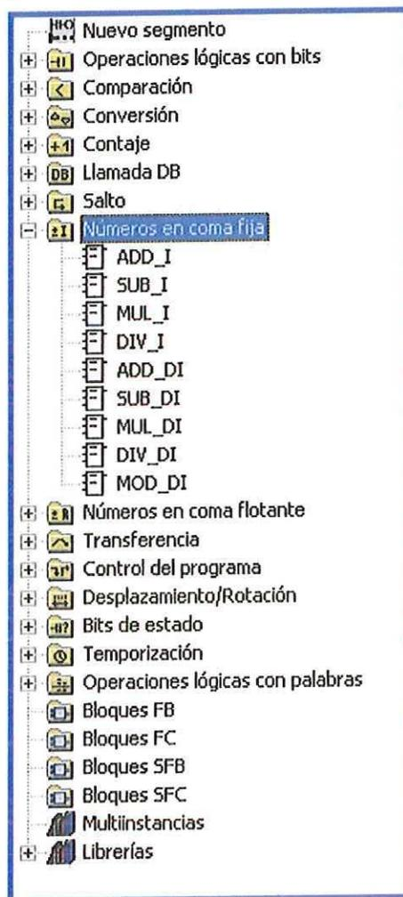
En un nuevo segmento insertamos la función `MUL_I`, y multiplicamos los almacenado en la marca `MW10` por la pendiente de la gráfica. El resultado se verá en la salida analógica `PQW752`.
