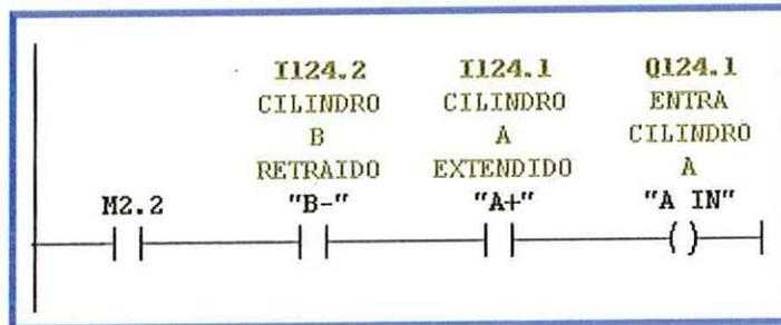
El paso se memoriza en M2.3, la activación de esta memoria resetea a la bobina que controla A OUT (paso 1).
