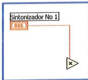
El valor dentro de sintonizador se debe multiplicar por 2, dando clic derecho sobre el puerto Y de la función Multiply aparece un menú emergente. Seleccione la opción **Create** y posteriormente **Constant**.
