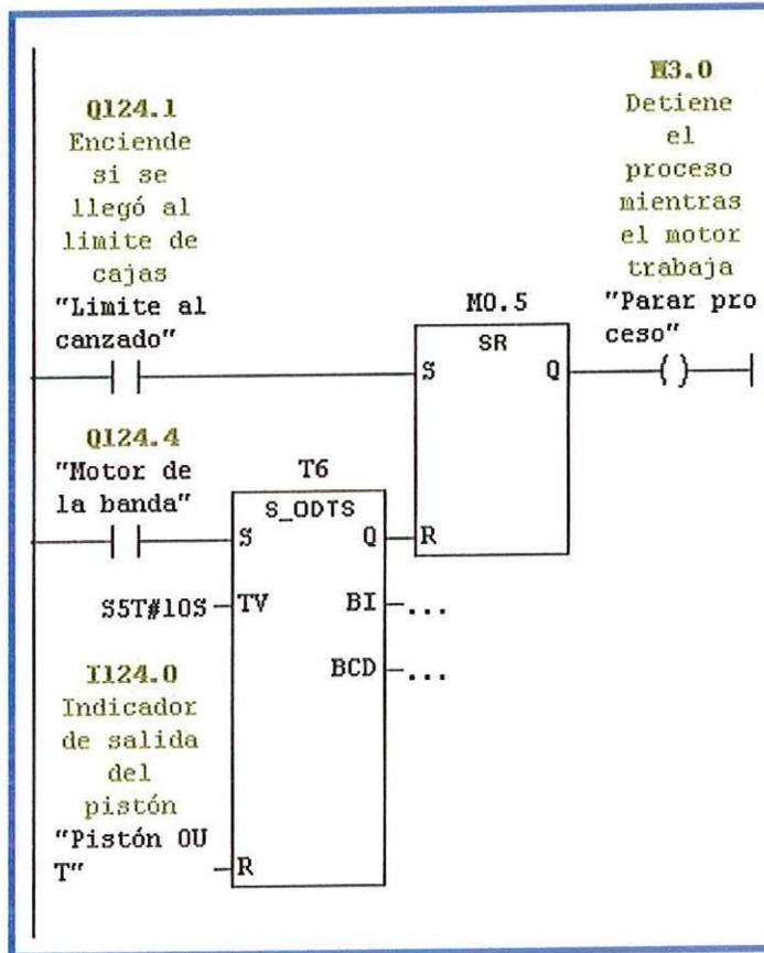
Ubique *Parar proceso* en forma negada a la salida de Q, en el primer segmento de operaciones donde se controla a la válvula.
