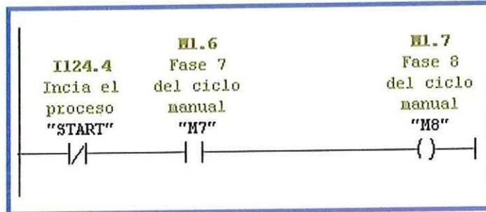
La ultima fase desactiva la primera, así que esta fase negada se agrega al segmento de M1. Al desconectarse M1 las demás fases se desconectan automáticamente.
