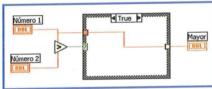
Ahora con el puntero del Mouse cambie la función Case de True a False. Notará que la conexión desaparece, ahora conecte N2 con el visor.
