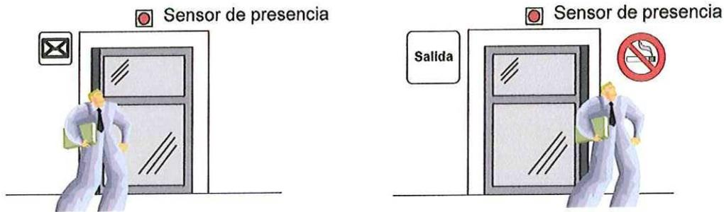
Obviamente utilizar un solo PLC para controlar una sola puerta sería bastante excesivo. Sin embargo, puede ser útil si en el mismo edificio existe una mayor cantidad de sistemas del mismo tipo. Y no sólo eso, se podría usar también para controlar el encendido de las luces, el accionamiento de las bandas transportadoras que llevan las cartas, etc.
