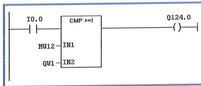
El comparador CMP>=1 se encarga de determinar si IN1 es mayor o igual que IN2, de ser así la salida conectada a Q124.0 se activa. Esta comparación solo se lleva a cabo si el valor de la entrada conectada a I0.0 es 1.
