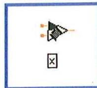
Podrá identificar los puertos por la aparición de un mensaje emergente de color amarillo sobre el área de trabajo, Multiply consta de dos entradas X y Y ubicadas en la parte posterior de la función, su salida X\*Y esta ubicada en la parte delantera.
