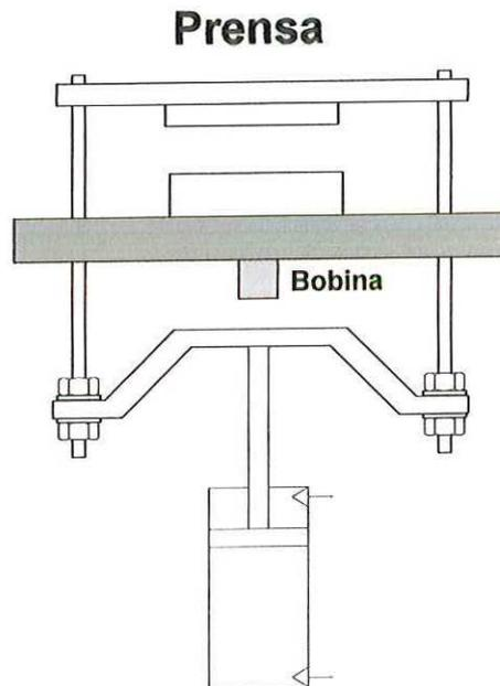
La prensa es un mecanismo neumático que sella la bolsa a través de un impulso eléctrico que la calienta (el impulso dura 3 segundos) provocando la fusión.
