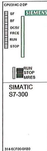
Con la alimentación ya establecida, es necesario conectar el cable PG-PC entre el computador (a través del puerto serial COM1 o COM2) y el PLC (en la bahía de conexión de la CPU denominada MPI).
