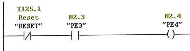
Es necesario generar el efecto de detención en los cilindros cuando se da STOP. Para esto se realiza la siguiente modificación a la etapa de potencia.
