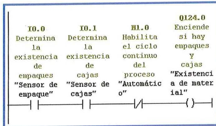
para hacer que el proceso se detenga si la existencia de empaques o de cajas se acaba, se agregan estas dos señales de forma tal como se muestra en la gráfica, de esta forma el proceso no arrancará si se da START o si esta trabajando en automático.
