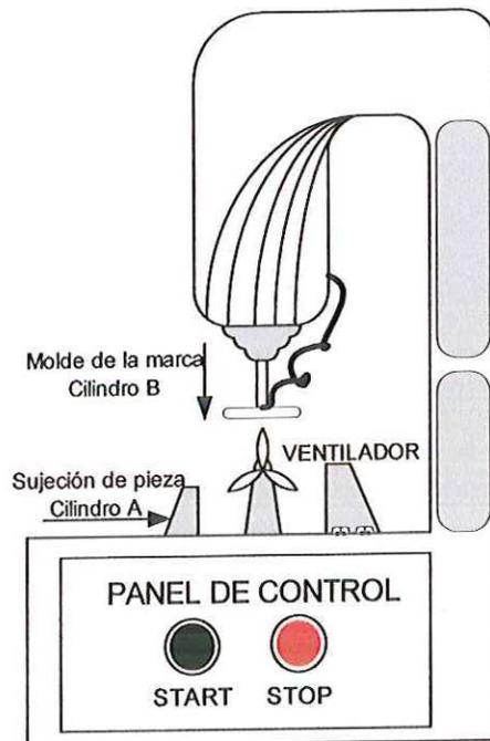
Los sensores emiten señal cuando el pistón ha entrado (A- , B-) y salido totalmente (A+ , B+). Ambos pistones son controlados con válvulas de doble bobina. El proceso inicia al presionar START, y desarrolla el siguiente ciclo continuamente mientras no se presione STOP.
