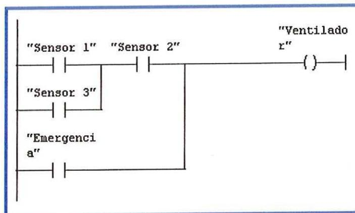
Ahora se procederá a cargar el programa realizado al PLC, a través del icono *cargar al módulo*. Una vez el PLC este listo, de clic sobre el icono *observar* y con el módulo de simulación de entradas y salidas digitales procederemos hacer pruebas.
