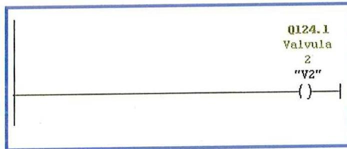
Las válvulas son accionadas en dos modos el *Manual* y el *Automático*, en el modo *Automático* el pistón B (observando la gráfica de tiempos) es el primero en salir, es decir se expande en la fase 1 (CR1), así que cuando CR1 (M0.0) se active su estado accionará directamente a V1 la cual controla a la válvula del pistón B.
