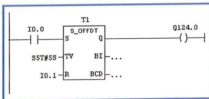
Esta opción denominada S\_OFFDT (S\_AVERZ en alemán), funciona de la siguiente forma, cuando la entrada S (conectada a I0.0) cambia de 0 a 1, la salida Q (conectado a Q124.0) **se mantiene encendido hasta el tiempo que indique TV** (o TW en alemán), **si S se mantiene en 1 la salida se estará siempre activada y el contador se detiene**. Si R=1 en cualquier momento Q se apagará. Un cambio de S a 0 no afecta el trabajo del temporizador.
