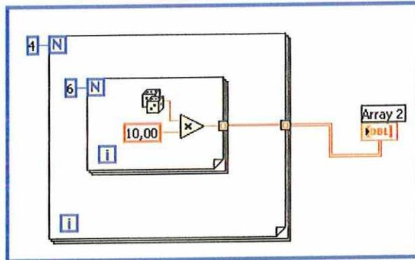
De esta forma se crea una matriz de 4 filas por 6 columnas. El for externo determina el número de filas, mientras el for interno el número de columnas.
