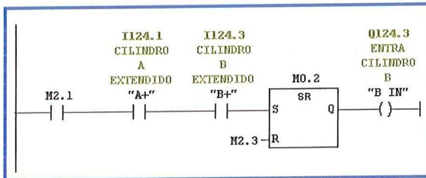
Se memoriza este paso en M2.2. Apenas se activa esta marca, se encargará de resetear el F-F que controlaba a la bobina de B OUT (paso 3). De esta forma se evita que ambas bobinas estén activas a la vez.
