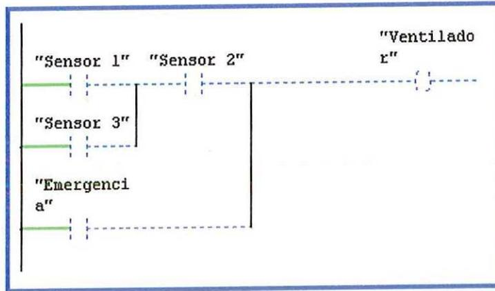
En el momento en que el sensor de temperatura del líquido "y" el sensor de temperatura del vapor hayan alcanzado su punto crítico emitirán la señal de activación al dispositivo de ventilación. Observe que esta condición es de tipo AND la cual expresa que la salida será 1 sólo si todas las entradas son 1.
