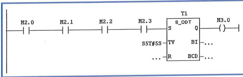
Para garantizar que el proceso se reinicie después de haber oprimido START, se memoriza su pulsación con un F-F, el dato queda almacenado en la marca M3.1. Para apagar el proceso se conecta a la entrada R el botón STOP.
