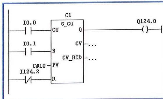
El funcionamiento de este contador es similar a los otros, esta función realiza un conteo ascendente. El valor de inicio de conteo (PV) se carga con S, y cada vez que entra un pulso por CU el valor se incrementa de a uno. El estado de Q será 1 siempre y cuando el valor del contador no sea cero.
