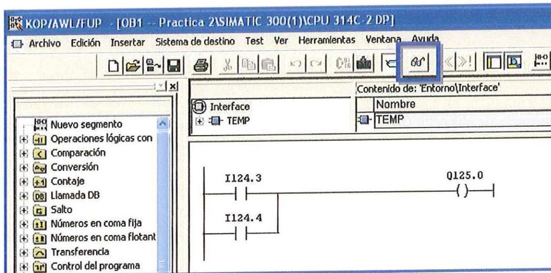
9) **Ponga el PLC en RUN**, el programa interpreta este cambio mostrando en tiempo real los estados de los elementos del programa, para probar, active uno de los sensores y observará que se ilumina su elemento correspondiente. La opción conlleva a una reacción en este caso se accionará la puerta.
