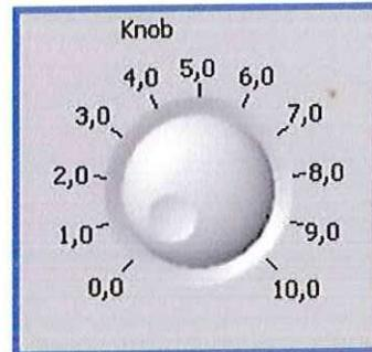
Para poder desplazar la perilla basta con dar clic sobre el icono en forma de mano con el dedo índice levantado (*Operate Value*) para transformar el cursor en una figura similar. Ahora desplace el Mouse hacia el objeto y ubíquese sobre la perilla, con clic sostenido arrastre el indicador hacia cualquier otro número.
