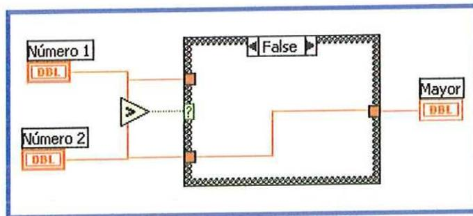
Case crea un subdiagrama para cada condición; se puede desplazar entre ellas usando el puntero del Mouse.
