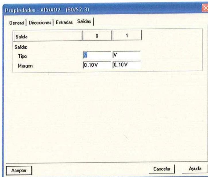
**Configure la salida 0 para que genere una señal de voltaje con un rango de 0 a 10 voltios.**
