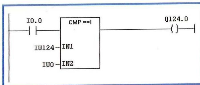
El comparador  $CMP==1$  se encarga de determinar si los datos almacenados en las entradas  $IN1$  e  $IN2$  son iguales, de ser así la salida conectada a  $Q124.0$  se activa. Esta comparación solo se lleva a cabo si el valor de la entrada conectada a  $I0.0$  es 1.
