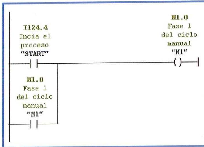
**Nota:** el ciclo manual no requiere del uso de la señal de los sensores.
