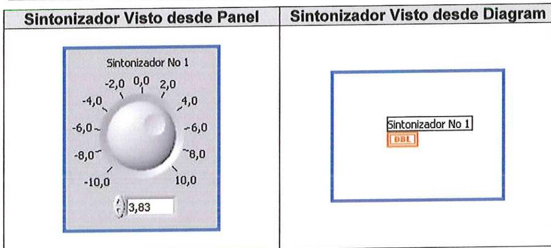
Diagram interpreta al sintonizador como una variable, sólo que esta es modificada por el usuario, el origen de los datos es transparente para Diagram, el interés en esta ventana es del procesamiento y generación de una señal.
