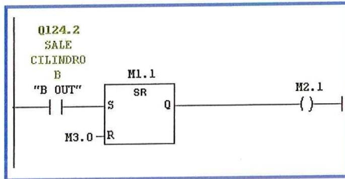
El siguiente paso es el regreso del pistón B después de haber realizado su función de marcar el utensilio. Las condiciones para que se cumpla este paso son A+, B+ y M2.1 (el paso anterior realizado). R se conecta con la marca M2.3.
