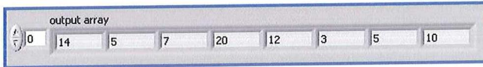
**Replace Array Subset:** reemplaza un elemento del array (*index*) por otro (*new element/subarray*).
