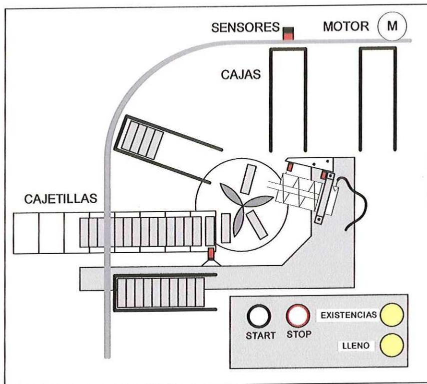
El proceso inicia al accionarse START y funcionara repetitivamente hasta que STOP sea presionado y detenga el proceso en su totalidad, o, si la existencia de cajas o cajetillas se agota la luz indicadora se apaga, por tanto el proceso se detiene.
