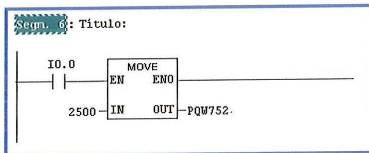
Habilite la entrada 0.0 y con el multímetro observe el valor del voltaje que arroja la salida analógica.
