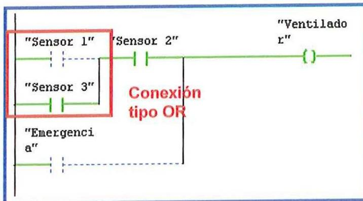
Si por alguna circunstancia el operario considera que es necesario encender el ventilador, lo puede hacer directamente activando el interruptor de emergencia, observe que todo el sistema está gobernado por una condición tipo OR que enciende el ventilador sin importar la condición en que se encuentran los sensores.
