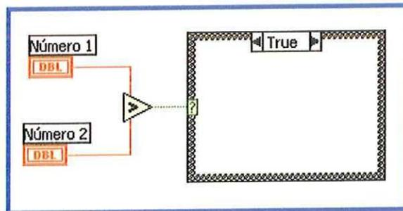
En el caso que N1 sea mayor que N2, la respuesta de la función Mayor será True, el caso contrario será False. Se usará el visor para comprobar si esta primera comparación se hizo de forma correcta. Primero, con la función case en True se conecta N1 con el visor, procurando que la línea que los une pase a través de la función.
