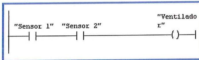
La segunda condición de activación se da en el momento que tanto el sensor del vapor como el sensor de temperatura del tanque se activen.
