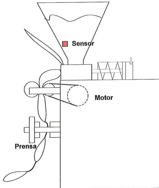
Mediante un mecanismo neumático, la tolva se encarga de administrar una cierta cantidad de producto dentro de un empaque, cuando esta listo, un motor se encarga de llevar esta parte del empaque hacia la prensa.
