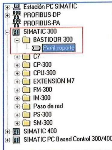
**Nota:** SIEMENS tiene predeterminado para todos sus PLC que debe existir un **orden en la configuración** de los elementos, este orden es el siguiente:
