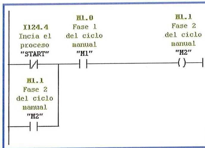
M3, M4, M5, M6 y M7 se configuran de la misma forma, recuerde que según la gráfica en M3, M5 y M7 se oprime START y los estados restantes son de espera.
