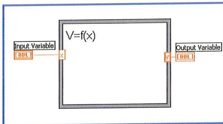
Formula Node ejecuta la función matemática que está comprendida dentro de su espacio de trabajo, mediante letras se determinan las variables y usando unos enlaces se conectan esas variables a los datos de entrada y de salida.
