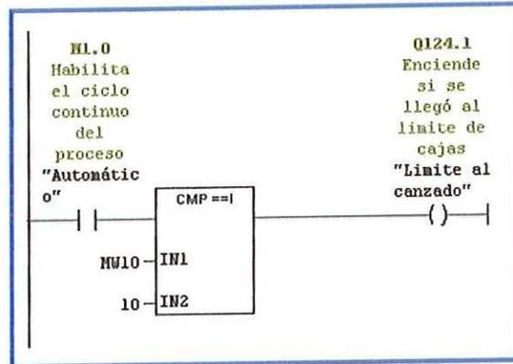
La señal de límite alcanzado activa un temporizador (T5) con retardo a la conexión (S\_ODTS), espere un tiempo de 2 segundos para que retarde la activación de otro temporizador (T3) el cual controla al motor de la banda y lo mantendrá activo por 5 segundos (tiempo que tarda en retirar y poner otra caja en su lugar).
