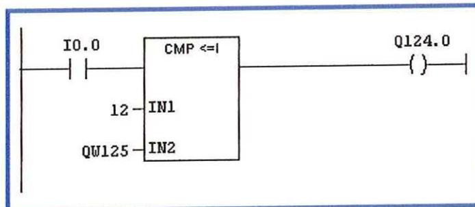
El comparador  $CMP \leq 1$  se encarga de determinar si IN1 es menor o igual que IN2, de ser así la salida conectada a Q124.0 se activa. Esta comparación solo se lleva a cabo si el valor de la entrada conectada a I0.0 es 1.
