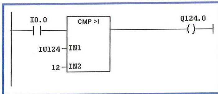
El comparador CMP>1 se encarga de determinar si IN1 es mayor que IN2, de ser así la salida conectada a Q124.0 se activa. Esta comparación solo se lleva a cabo si el valor de la entrada conectada a I0.0 es 1.
