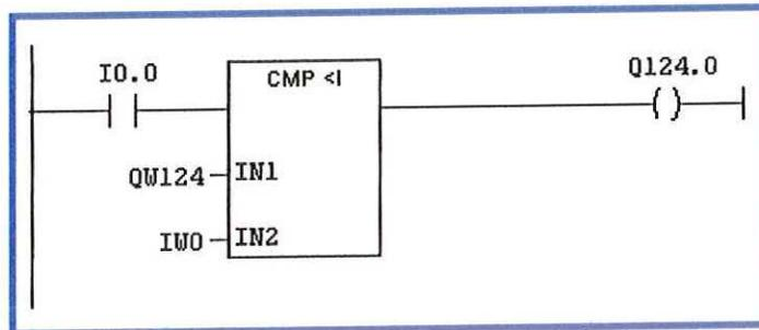
El comparador CMP<1 se encarga de determinar si IN1 es menor que IN2, de ser así la salida conectada a Q124.0 se activa. Esta comparación solo se lleva a cabo si el valor de la entrada conectada a I0.0 es 1.
