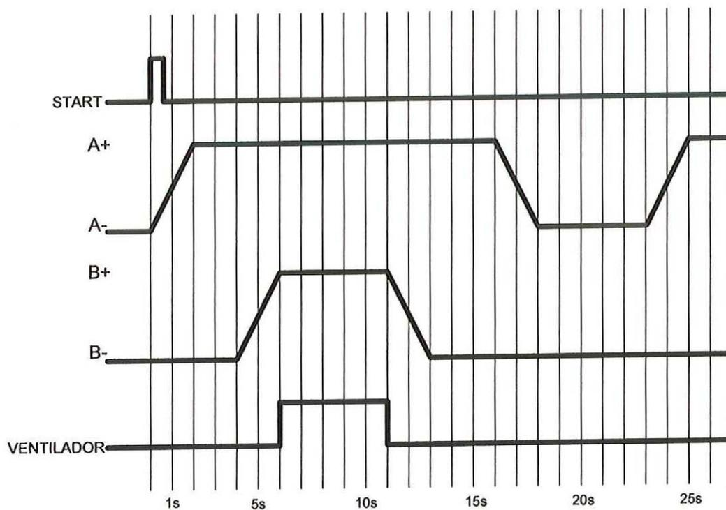
El tiempo que se toma la máquina para volver a iniciar un ciclo es de 5 segundos, tiempo que tarda en llegar una nueva pieza. Al presionar STOP se cumple lo que haga falta para finalizar el ciclo y se apaga la máquina. Diseñe el programa que efectúa este funcionamiento. La expansión y el regreso de los pistones son inmediatos.
