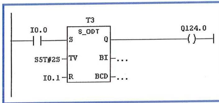
Esta opción denominada S\_ODT (S\_EVERZ en alemán), funciona de la siguiente forma, cuando la entrada S (conectada a I0.0) es 1 y se mantiene así, la salida Q (conectado a Q124.0) **se tardará el tiempo que indique TV** (o TW en alemán) **para activarse**. Si R=1 en cualquier momento Q se apagará y el conteo se detiene.
