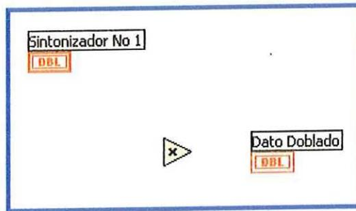
Multiply toma dos términos y los multiplica, esta función consta de tres bahías o puertos de conexión, dos entradas y una salida. **Para enlazar los objetos con la función**, en le submenú Tools seleccione con el Mouse el icono **Connect Wire**.
