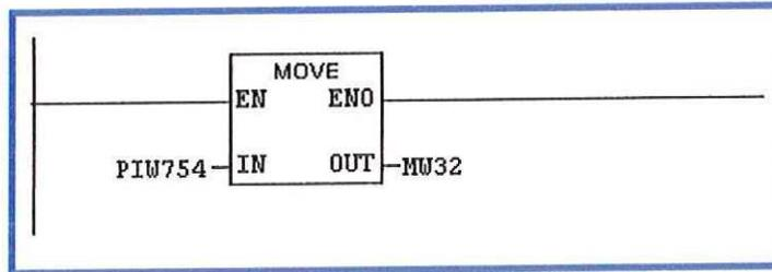
Se transferirán datos de la entrada análoga 1 (identificada con la dirección *PIW 754*) a la marca 32 (*MW32*), las entradas análogas tienen una magnitud de un Word por eso es necesario especificar el tamaño de la marca con la letra *W*.
