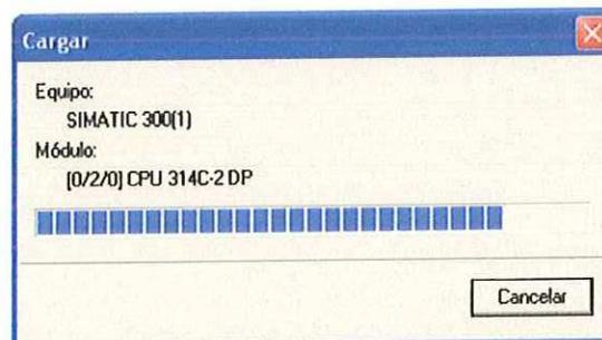
Una vez terminado este proceso, ubique la perilla de la CPU del PLC en **Run** y verifique que no se presentaron errores de configuración, esto significa que el aviso SF (System Failure) en el PLC no está encendido.
