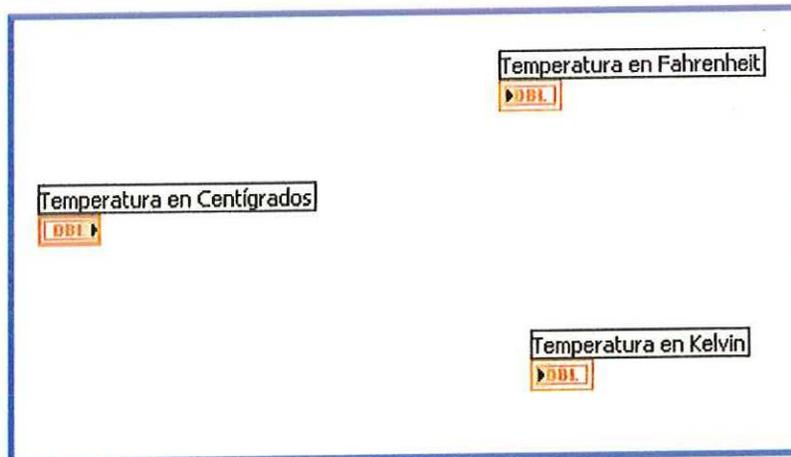
Se pueden identificar los objetos insertados por la etiqueta en la parte superior de cada imagen. A través de la casilla **Numeric** de la ventana **Functions** se insertan las funciones de multiplicación y suma necesarios.
