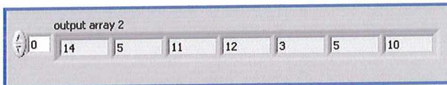
**Delete from array:** elimina uno o varios elementos (*length*) de un array, el recorte inicia desde la posición indicada (*index*). La función crea un nuevo array con los elementos eliminados (*deleted portion*)
