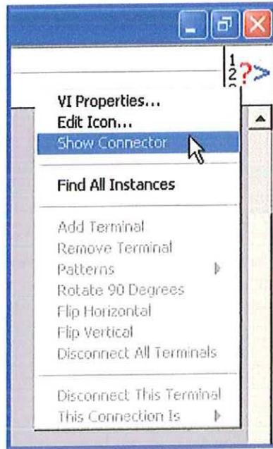
El icono cambia de figura. Y el mouse de forma, pasando al modo **Connect Wire**.
