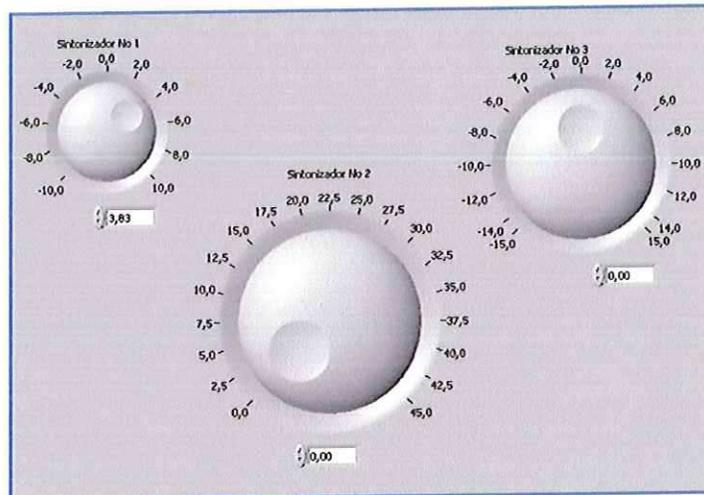
Se pueden **reordenar los objetos** insertado dentro de Panel para que tengan una apariencia ordenada. Lo primero, es alinearlos a un mismo margen horizontal, para hacer esto se recurre al submenú **Align Objects** ubicado en la parte superior de la ventana Panel.
