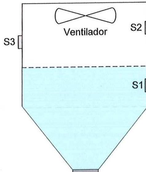
La planta está ubicada en una ciudad a nivel del mar, y los vapores del combustible son altamente explosivos, poniendo en riesgo la vida de los trabajadores. Para enfrentar este problema se le ha adaptado al tanque un sistema de ventilación que se activa cuando la temperatura se eleva a puntos críticos previamente establecidos.
