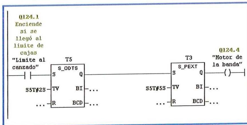
Es necesario resetear el primer contador T5, la señal de activación del motor de la banda puede hacerlo, de esta forma él estará listo ante otra secuencia.
