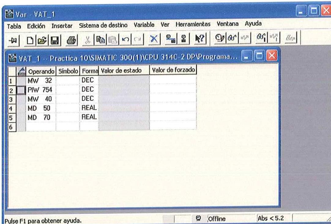
En la columna *Operando* digite las marcas donde se almacenan los datos importantes, como lo muestra la gráfica anterior, en la columna *Formato* puede determinar la forma en que quiere ver la variable, para MD70 asigne un formato de tipo *REAL*. Guarde estos cambios y de clic en el icono *observar*.
