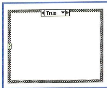
**Seleccionar caso de,** ejecuta una acción de acuerdo a una variable de entrada, esta se conecta casilla verde con signo de interrogación (?). Case trabaja de forma predeterminada con condiciones tipo boolean, mas si se conecta una variable tipo numeric a la casilla mencionada, Case modifica el rango de condiciones a variables numéricas.
