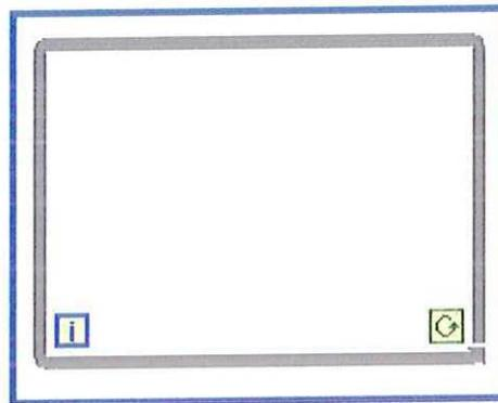
While ejecuta el diagrama que esta contenido dentro de su figura hasta que se cumpla la condición de salida. La condición es una variable tipo Boolean (TRUE o FALSE).
