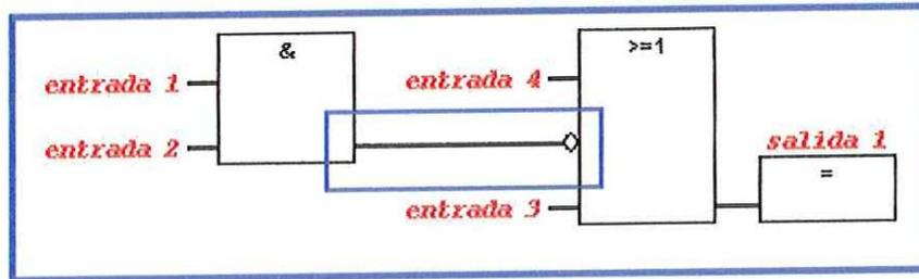
8. Crea un nuevo tramo, permitiendo el uso de una misma señal en otras instancias. En este caso la respuesta de la compuerta AND habilita una salida (*salida 2*) directamente, y a su vez actúa sobre la compuerta OR que rige a la salida 1.
