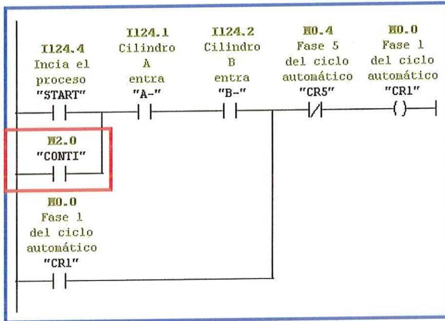
De esta forma el sistema adaptado a *Continuo* espera a que se oprima START para que funcione de forma indefinida ya que el sistema no se queda esperando una orden de inicio. **Guarde la función y cárguela al PLC.**
