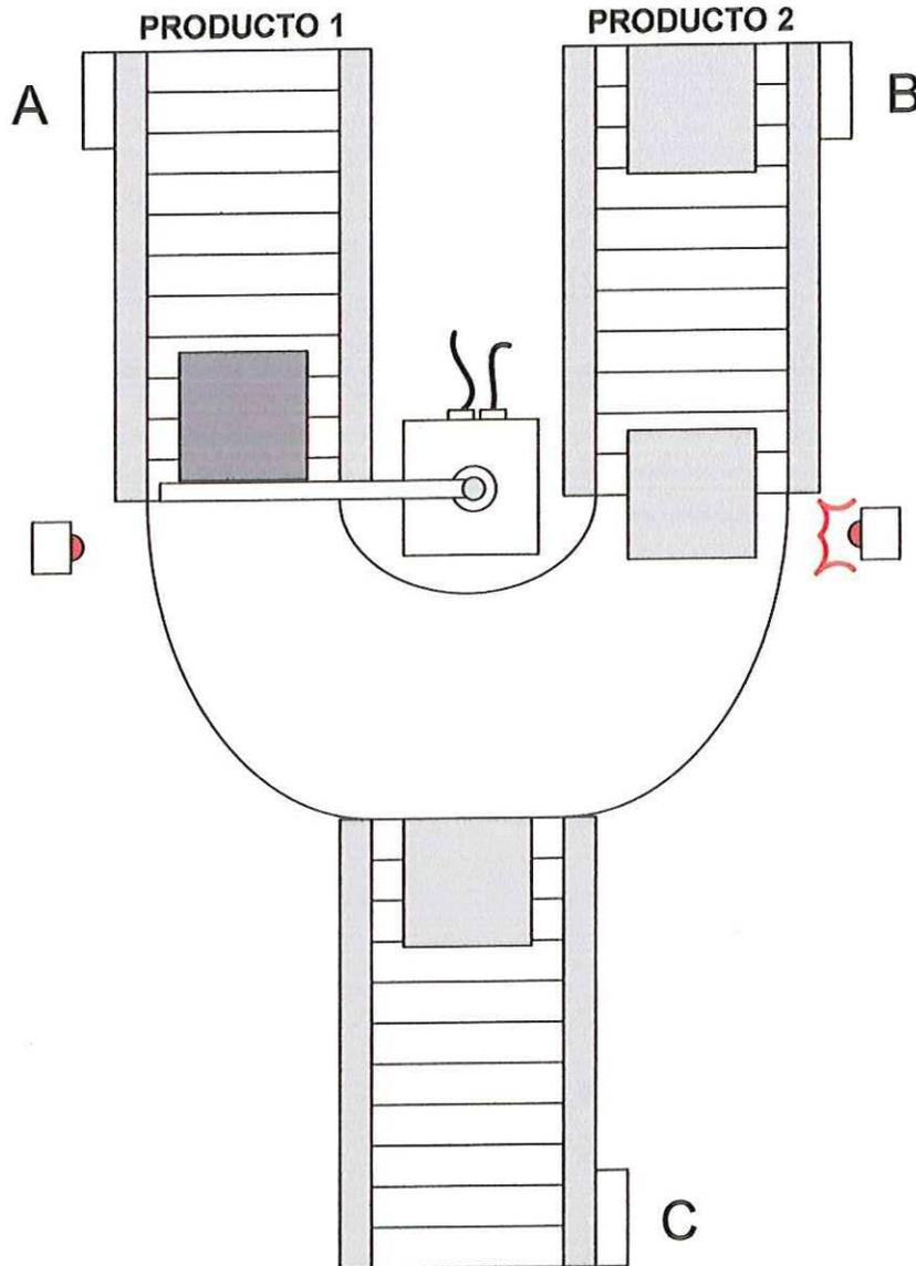
Se requieren 5 existencias de un producto para el empaque, así que se adaptó una portezuela accionada hidráulicamente la cual gira sobre su eje en cualquier dirección (la cual depende del puerto por donde está entrando el flujo), para que obstruya el paso de un producto. Para evitar el represamiento, el motor que acciona la banda del producto detenido se apaga durante el tiempo en que las 5 existencias del otro producto se empacan (el motor C esta en movimiento desde el encendido de la máquina).
