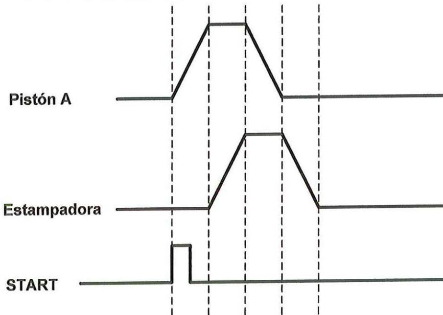
Este modo es denominado **Proceso Continuo**, el cual se ejecuta cuando se presiona **Continuo**, al hacer esto, el sistema queda en espera de que se presione **START**, cuando esto sucede, **realizará el proceso descrito en el Proceso Único de forma indefinida**, y sólo se detendrá cuando se presione **STOP** (normalmente cerrado sin enclavamiento). Si se vuelve a presionar **START** el sistema volverá a trabajar en el mismo modo.
