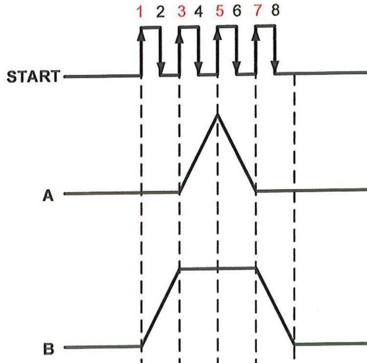
El modo manual de este proceso requiere de 8 fases en total, 4 donde se acciona START (las impares) y 4 donde no se presiona START (las pares). En *Tabla de símbolos* configure un byte de las marcas (en el ejemplo se usó la MB1) como se muestra a continuación.
