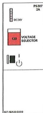
Una vez hecho esto conecte los tres cables al PLC y enciéndalo. La PS se encarga de suministrar una alimentación en Corriente Continua adecuada para el funcionamiento del equipo, esta se encuentra entre los terminales L y M (neutro) quienes suministran 24 VDC, note que la CPU tiene unos terminales iguales, conéctelos y así estará alimentada.
