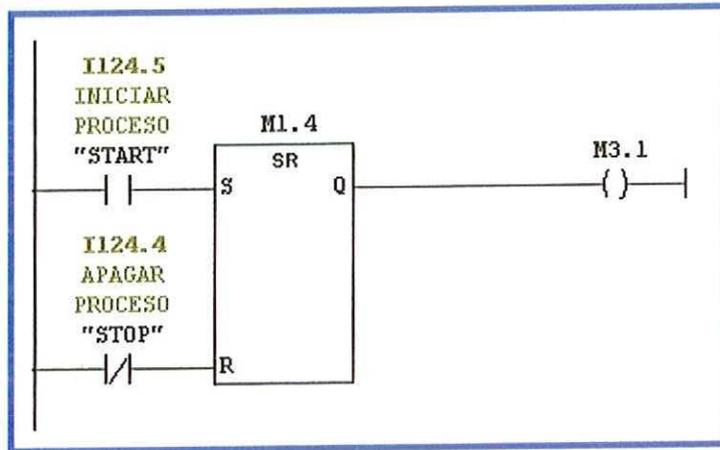
Al ser activado la marca M3.1 (puesta en **OR** con START) esta mantendrá el proceso en operación hasta que se presione STOP el cual hará que se desactive y se corte el lazo de activación del F-F que controla a la bobina de A OUT.
