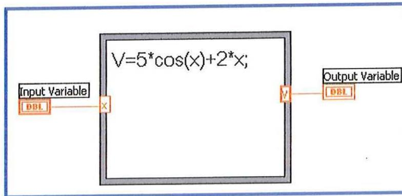
Al final se agrega una objeto entrada (*Input variable*) a la variable de entrada y un *Output variable* a la salida de la función. En Panel se verán estos indicadores.
