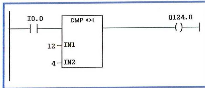
El comparador CMP<>1 se encarga de determinar si los datos almacenados en las entradas IN1 e IN2 son diferentes, de ser así la salida conectada a Q124.0 se activa. Esta comparación solo se lleva a cabo si el valor de la entrada conectada a I0.0 es 1.
