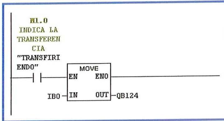
De esta forma mientras se mantenga habilitada la marca M1.0, todo cambio que se presente en el Byte de entradas simuladas (Panel de Control) se verá reflejado en las salidas que controlan cada uno de los elementos (Q124).
