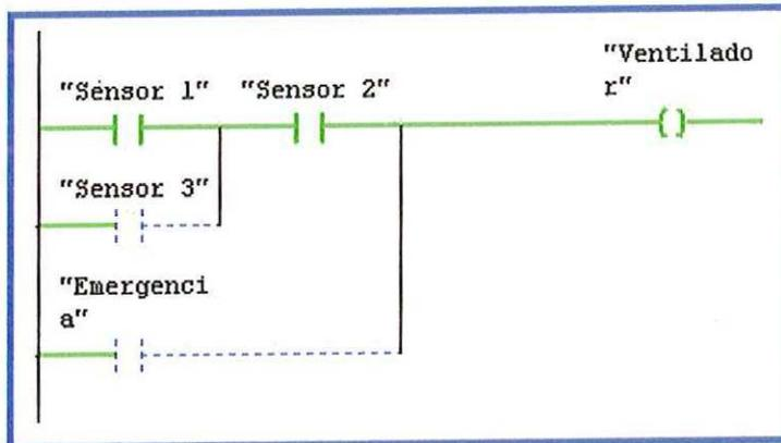
Los operarios establecen que una alta temperatura en el vapor del líquido no es crítica para que ella por si sola active el ventilador, sin embargo, un elevamiento en la temperatura de las paredes del tanque "o" del líquido son suficientemente alarmantes como para generar una señal de activación en el dispositivo. Observe que la condición entre el sensor 1 y el sensor 3, estando activo el sensor 2, es de tipo OR, la cual expresa que el resultado será 1 si una o la otra variable es 1.
