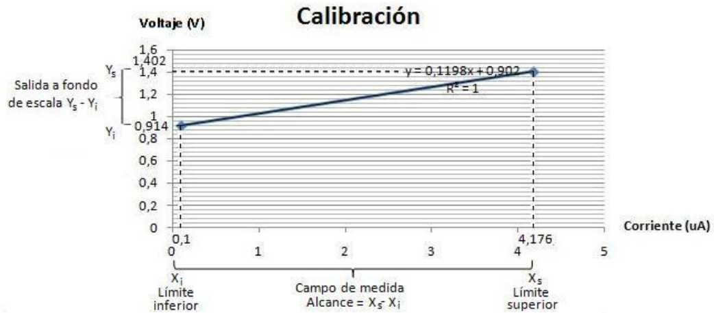
Figura 34 Representación del campo o rango de medida, alcance y salida a fondo de escala sobre la curva de calibración.
