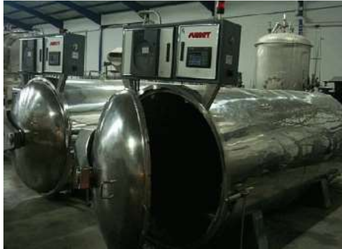
Figura 3. Cocedor de pulpas con molino triturador
