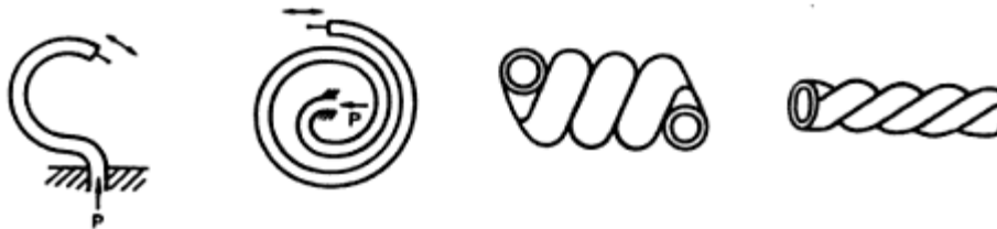
Figura 6. Distintas formas de los tubos de Bourdon.
