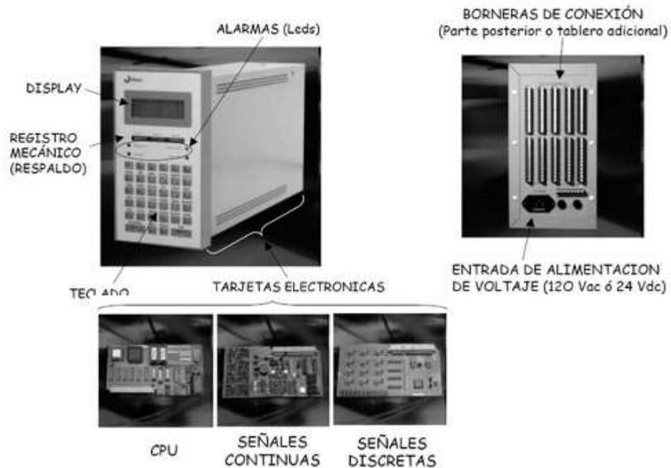
Figura 31. Componentes principales de un computador de flujo.
