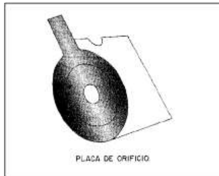
Figura 10. Placa o Platina de Orificio o Elemento Primario
