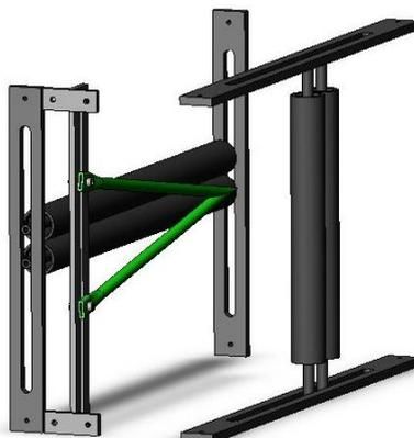
**Montaje del rollo doblado del material plástico:** Coloque el material plástico sobre el soporte horizontal, luego introduzca los conos de alineación en ambos extremos, ajústelos para mantener el rollo en la posición adecuada, para ser desplazado luego por los rodillos tensores.
