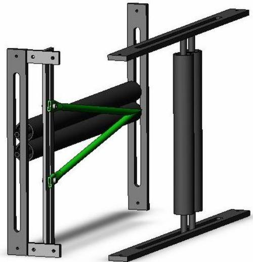
La herramienta dobladora puede ser ajustada verticalmente para ser centrado con el rollo del material plástico con el fin que el proceso de doblado sea simétrico.
