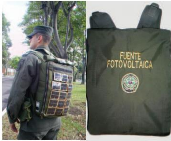
Figura 5. Fuente fotovoltaica portátil
