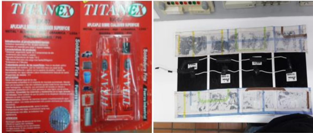
Figura 20: a) Soldadura fría b) Paneles pegados a la tela
