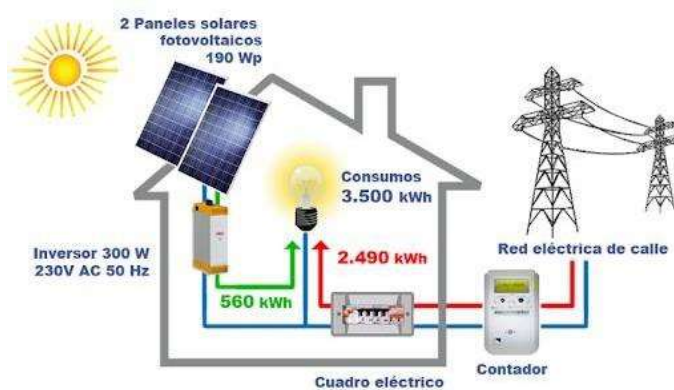
Figura 6. Sistema fotovoltaico conectado a la red
