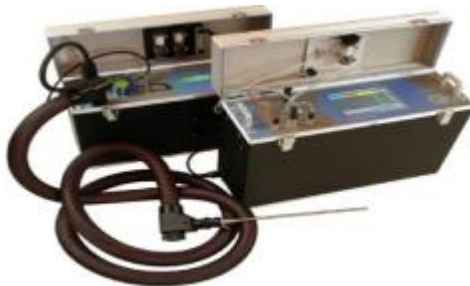
Ilustración 23. Analizador de gases de combustión PHOTON - MADUR GA – 21
