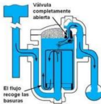
Ilustración 12. Trampas de vapor mecánica de balde invertido (Fuente; (regionales, 2007)) (Gaitán, 2011).
